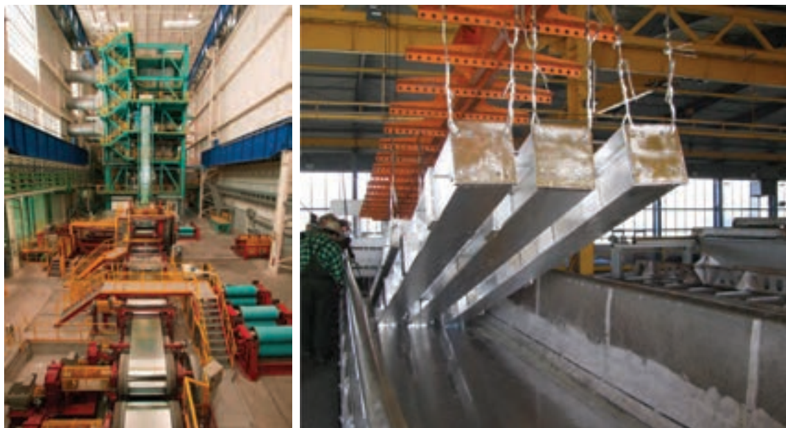
شکل ۱۵-۲- خط گالوانیزه کردن ورق و قوطی های فولادی
