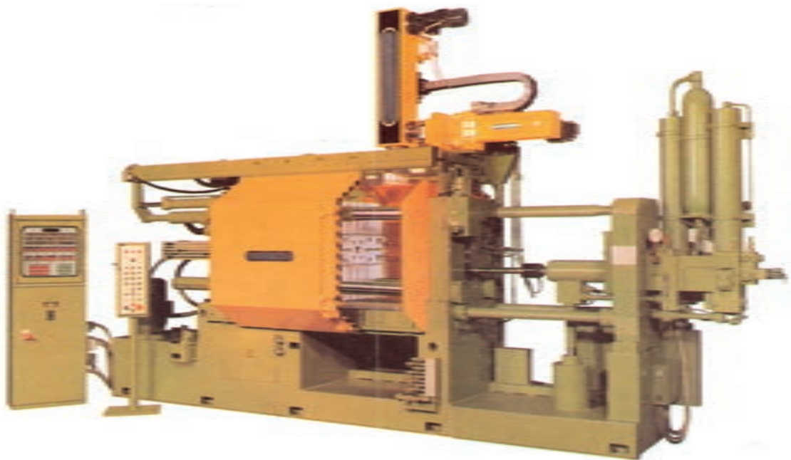
شکل ۲۶-۳ ماشین ریخته‌گری تحت فشار با محفظه سرد
