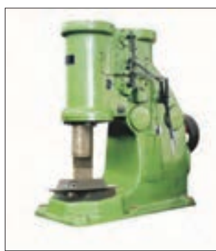
شکل ۱۰-۳- الف) دو نمونه از ماشین‌های پرس یا چکش‌های نیوماتیکی (ب) نمونه‌ای واقعی از یک پرس پتک کاری
