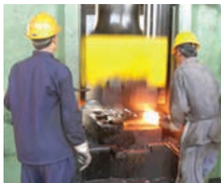
شکل ۱۰-۳- الف) دو نمونه از ماشین‌های پرس یا چکش‌های نیوماتیکی (ب) نمونه‌ای واقعی از یک پرس پتک کاری
