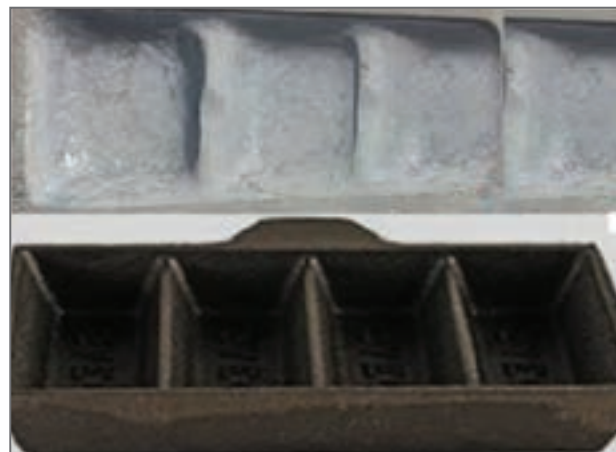
شکل ۴- قالب ریژه شمش ریزی
