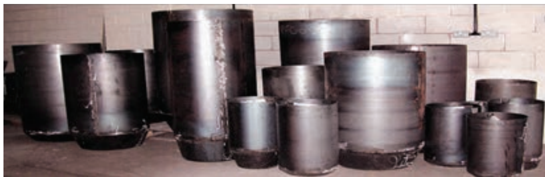
شکل ۱۶- انواع شابلون کوره در ظرفیت های مختلف
