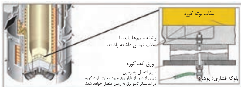
شکل ۱۰- شماتیک اتصال سیم ارت در کوره القایی
