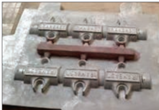
شکل ۶ - راهبار و راهباره ها روی مدل صفحه ای
