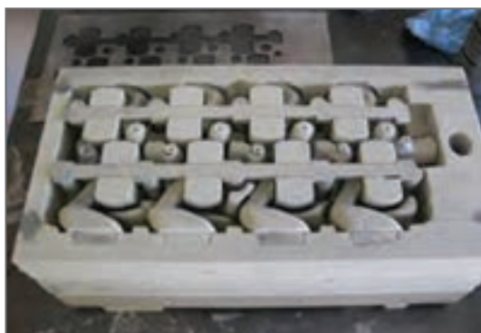
شکل ۲- قالب درجه زیرین یک قطعه صنعتی
