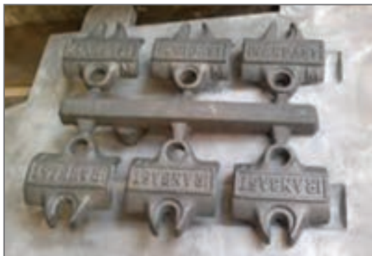
شکل ۷ - قطعات ریخته شده با سیستم راهبار و راهباره
