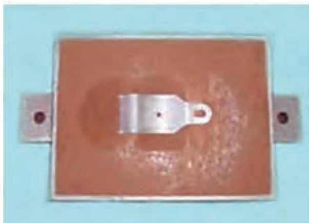
شکل ۲۱. سطح قالب‌های زیرین را پودر جدایش بزنید.
