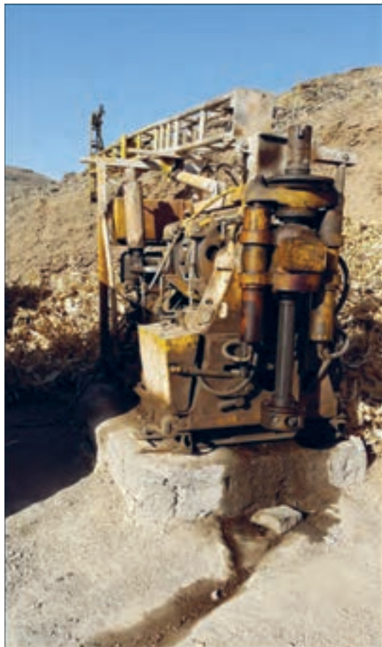
دستگاه حفاری قرار گرفته بر روی فونداسیون
