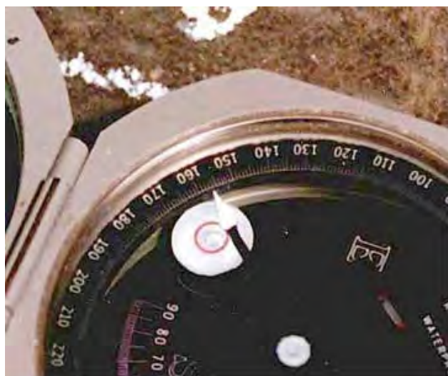
تراز کروی ( چشم گاو ) باید تنظیم شود
