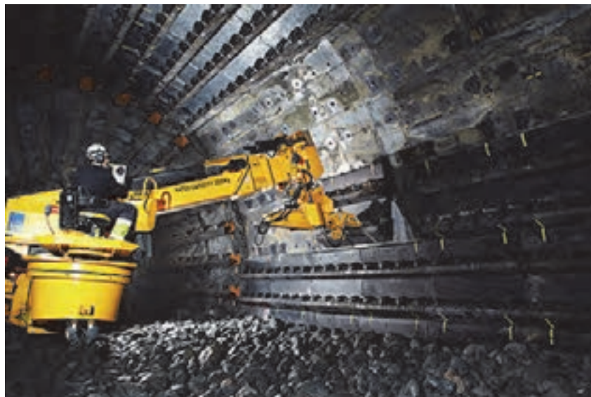
نحوه تعویض آسترهای دستگاه آسیا
