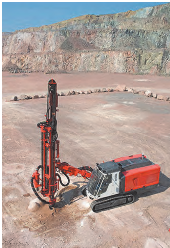
شاخص گذاری محدوده شبکه حفاری به وسیله سنگ چین
