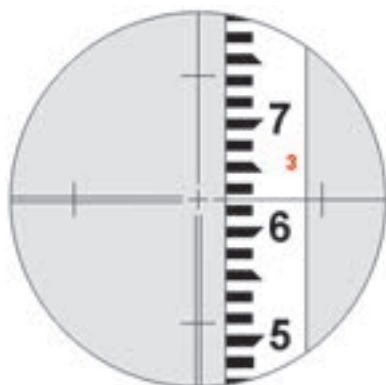
تارهای رتیکول داخل دوربین نقشه‌برداری
