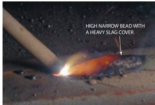
شکل ۴-۳۸: جوشکاری با طول قوس بسیار کم
