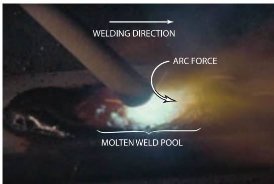
شکل ۴-۴۸: جوشکاری با زاویه پیشران
