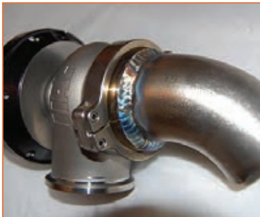
الف - جوش کاری دو قطعه فولادی
