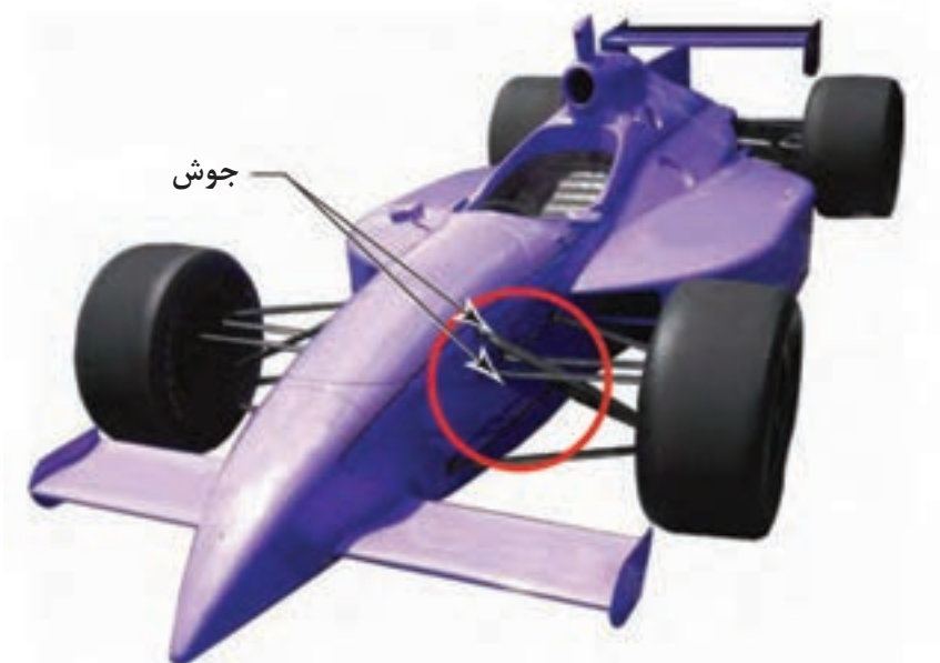
شکل ۴- اتصال دائم : جوش
