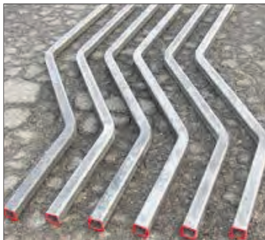
شکل ۳-۲۱- پروفیل با شعاع خم متفاوت
