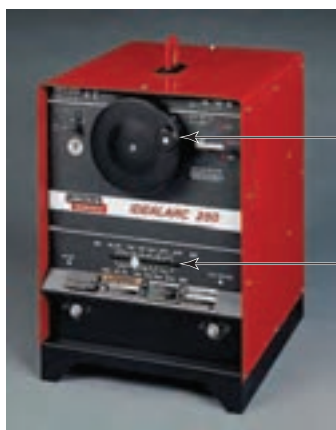
شکل ۴-۱۶: دستگاه جوشکاری با سیم پیچ متحرک
