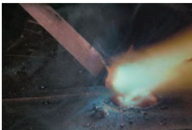
شکل ۴-۳۲: برقراری قوس با الکترودی که روکش آن کنده شده (عدم برقرار قوس پایدار)
