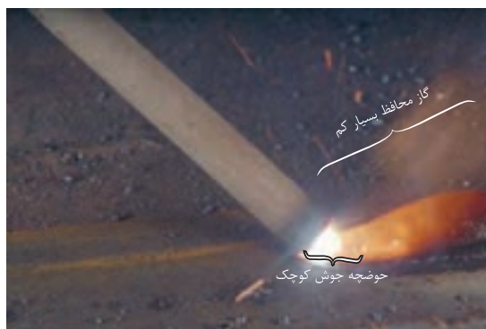
شکل ۴-۳۴: جوشکاری با آمپر بسیار پایین
