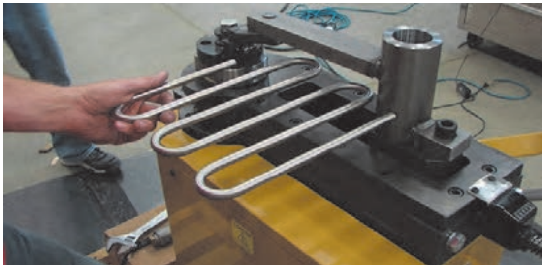
شکل ۲-۷: لوله خم شده -مبدل حرارتی-
