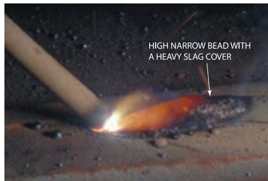
شکل ۴-۳۸: جوشکاری با طول قوس بسیار کم
