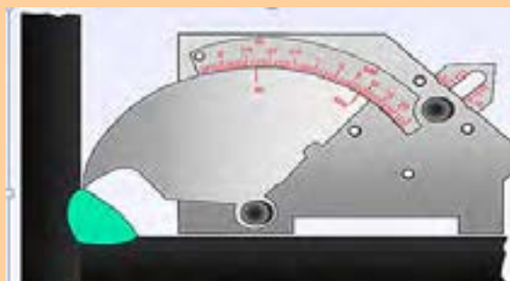
شکل ۱۲-۳- اندازه ساق جوش
