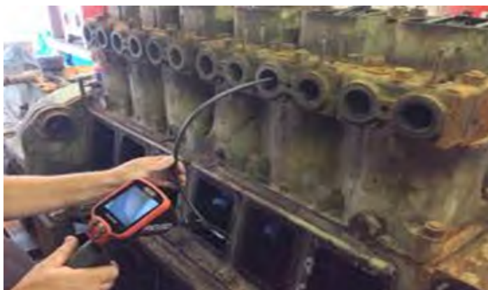
شکل ۱۳-۳- دستگاه آندوسکوپ
