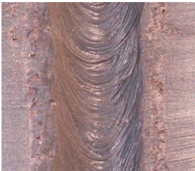
شکل ۲۷-۱: ساق (toe) جوش یکنواخت
