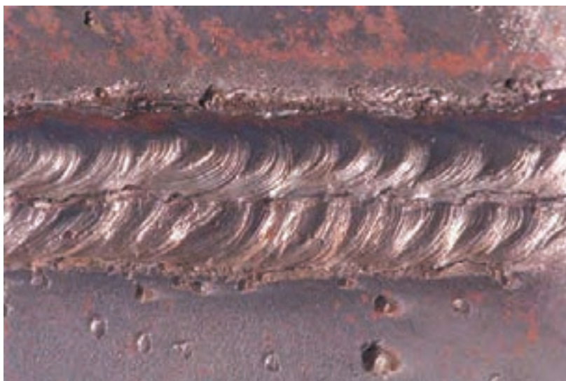
شکل ۴۰-۱: اندازه گرده جوش در پاس پوششی
