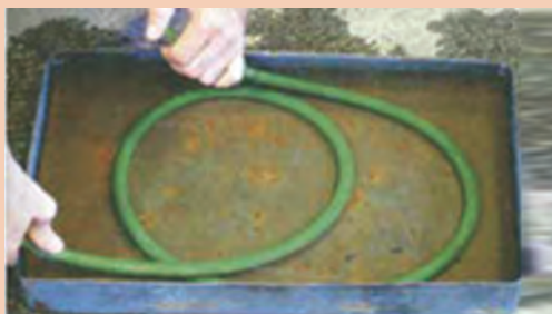
شکل ۳-۳۸- کنترل سلامت شیلنگ‌ها
