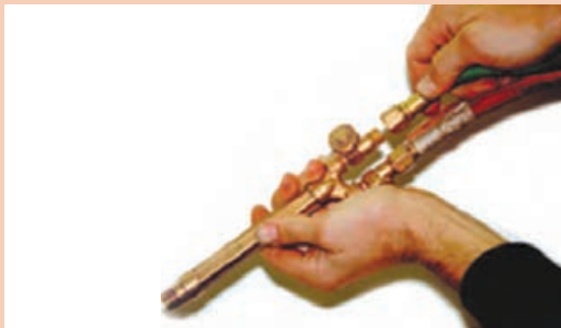
شکل ۳-۳۴- بسته شدن شیر اطمینان در اتصال شیلنگ‌های مشعل جوشکاری اکسیژن (سبز) و استیلن (قرمز)
