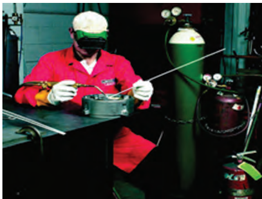
شکل ۱-۴- تجهیزات و فرایند زردجوش
