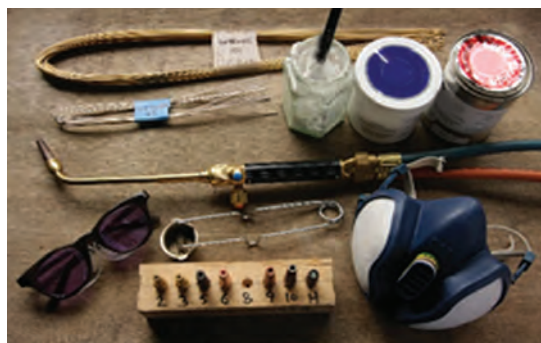
شکل ۷-۴- تجهیزات مورد استفاده فرایند زردجوش
