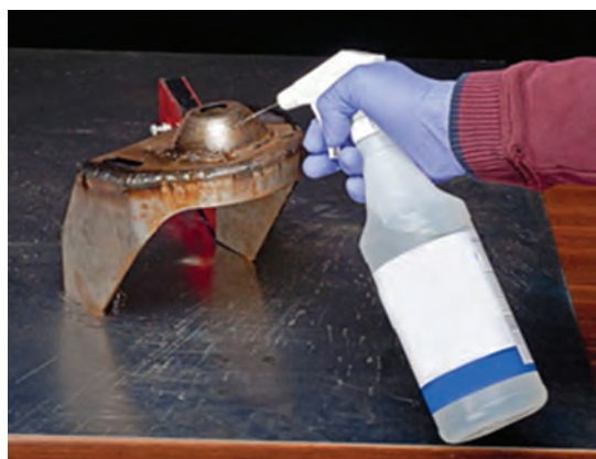
شکل ۴-۲۲- تمیزکاری بعد از جوشکاری توسط محلول شیمیایی
