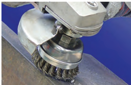
شکل ۱۱-۴- تمیزکاری توسط ابزارهای مکانیکی
