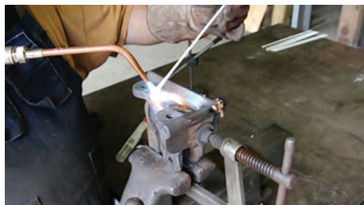
شکل ۴-۱۵- فیکسچر مورد استفاده شده در فرایند زردجوش
