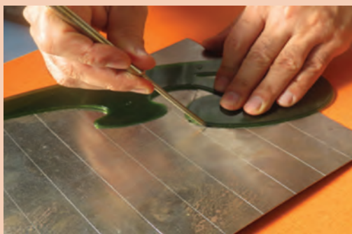
شکل ۳۴-۱- خط کشی ورق فلزی با پیستوله
