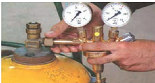
شکل ۳-۱۸- بستن رگولاتور به کپسول
