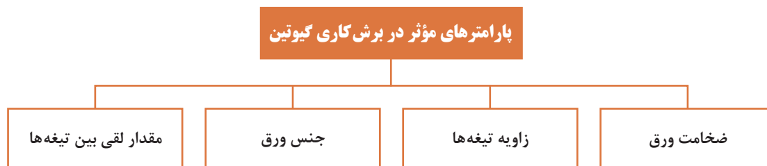
شکل ۱-۱۰- پارامترهای برش کاری با گیوتین
