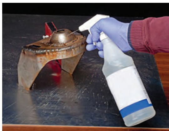
شکل ۴-۲۲- تمیزکاری بعد از جوشکاری توسط محلول شیمیایی
