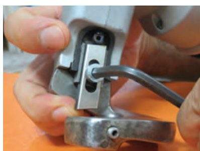
شکل ۱-۲۸- تنظیم فاصله افقی و عمودی تیغه‌ها
