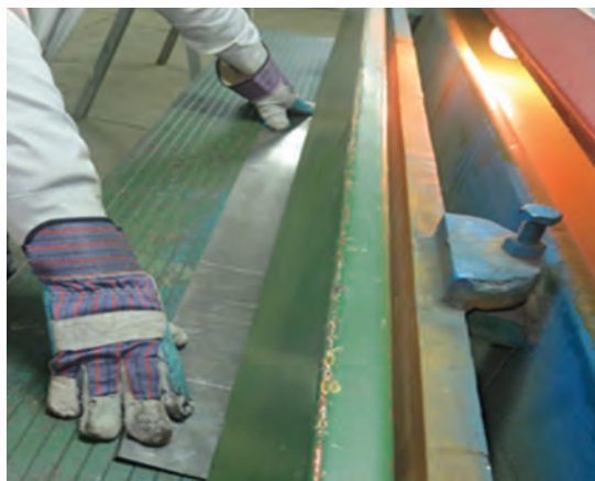
شکل ۷-۱- تنظیم خط برش با چشم توسط اپراتور
