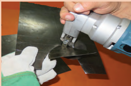
شکل ۳۵-۱- برش کاری با قیچی نیبلر
