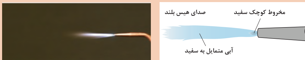
شکل ۳-۴۰- تنظیم شعله اکسید
