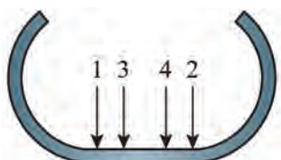
۵ اجرای انحنا به طور متناوب از دو سر ورق
