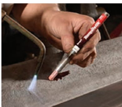
شکل ۴-۱۸- اندازه‌گیری دما توسط گچ‌های حرارتی
