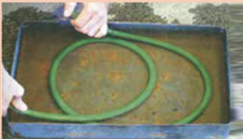
شکل ۳-۳۸- کنترل سلامت شیلنگ‌ها
