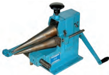
شکل ۲۲-۲ نورد خاص در تولید مخروط ناقص
