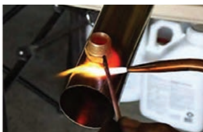
شکل ۴-۱۷- استفاده از شعله اکسی‌استیلن
