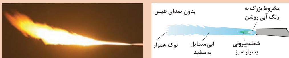
شکل ۳-۳۹- تنظیم شعله احیا (کربن ده)
