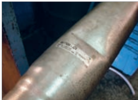
شکل ۱۵-۳- مشاهده آثار ضربه روی سطح میل گاردان
