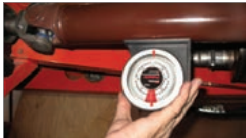
شکل ۱۳-۳- روش استفاده از زاویه سنج میل گاردان
