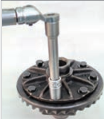
شکل ۵۰-۴- بستن پیچ‌های کرانویل
