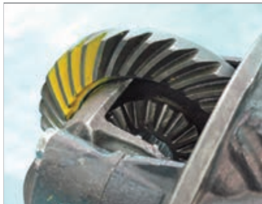
شکل ۴-۲۸- استفاده از رنگ برای کنترل
