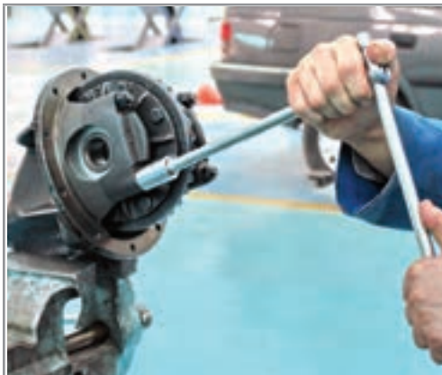
شکل ۵۳-۴- بستن کپه یاتاقان‌ها
