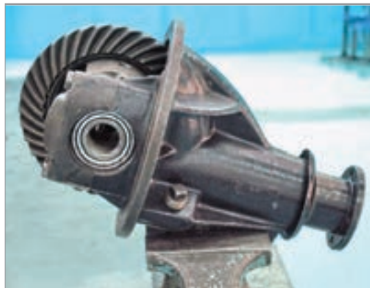
شکل ۴-۲۷- بستن مجموعه دیفرانسیل روی گیره
