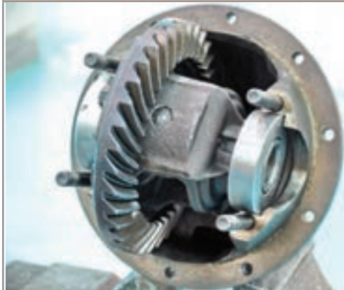
شکل ۵۲-۴- استفاده از رولبرینگ آزمایشی
