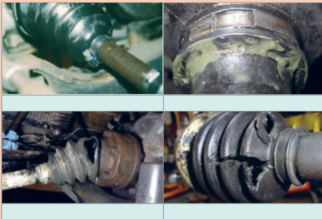
شکل ۱۷-۵- روش بررسی ظاهری پلوس‌ها
