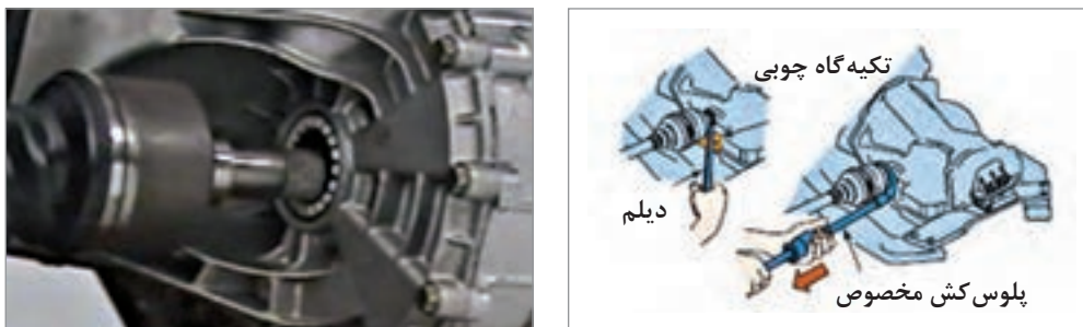
شکل ۱۹-۵ - خارج کردن پلوس با ابزار مخصوص
