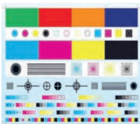
شکل ۱۴-۲- نمونه نوارها و علائم کنترل
