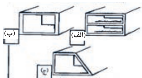
شکل ۵-۴ سطح مقطع تقویت شده
