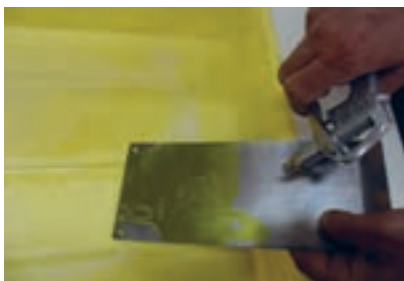
شکل ۴-۲۰- خارج کردن داروی ظهور از گودی‌ها
