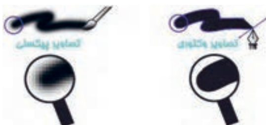
شکل ۲-۵- تفاوت تصویر رستری و وکتوری
