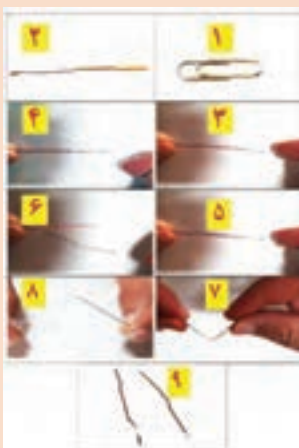
شکل ۵-۱۳ آزمایش بارگذاری بر روی یک مفتول گیره کاغذ چرخ
