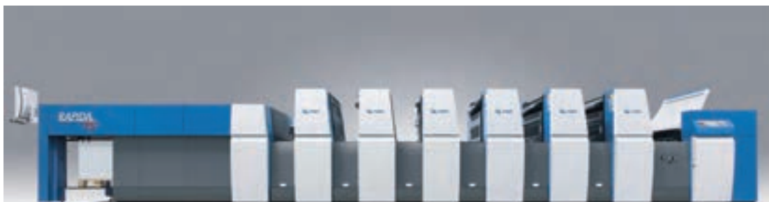
شکل ۳-۷۱- ماشین چاپ افست لیتوگرافی
