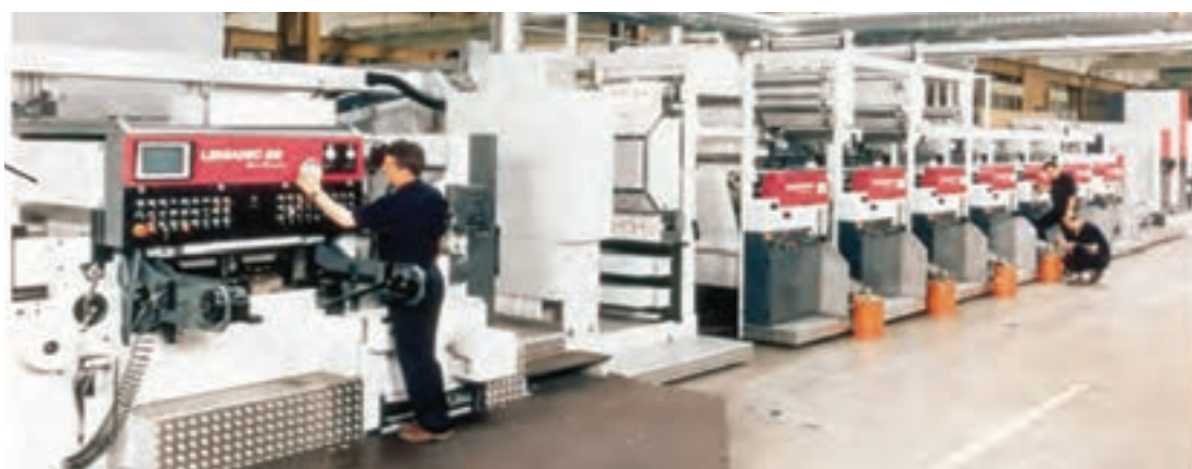
شکل ۳-۶۹ – ماشین چاپ فلکسوگرافی
