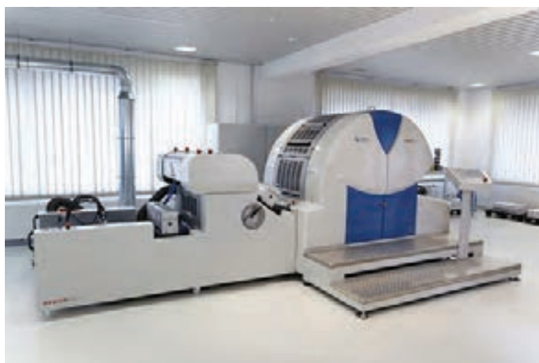
شکل ۳-۷۲- ماشین چاپ افست خشک (نمای خارجی)
