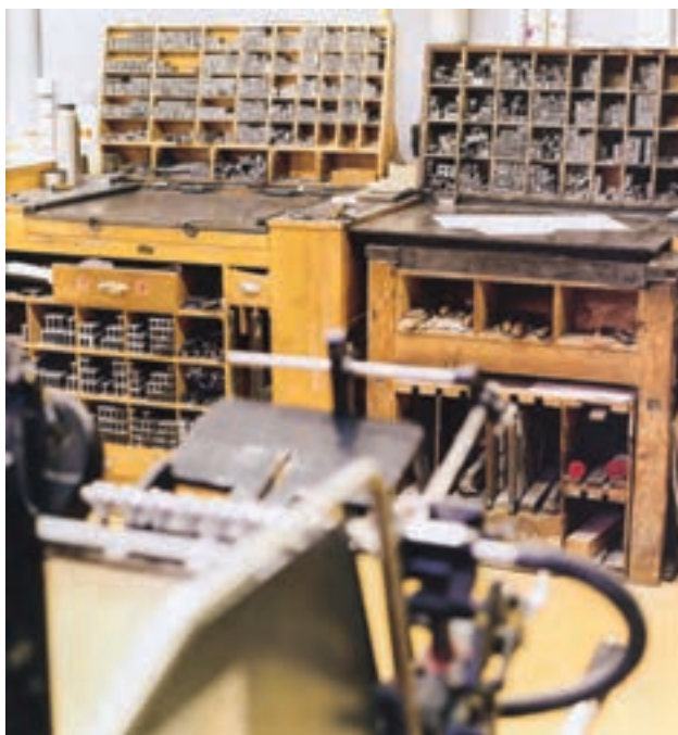
شکل ۱۸-۱ میز کار و فرم‌بندی چاپ برجسته
