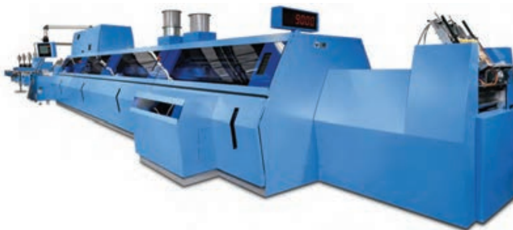
شکل ۳-۸۵- دستگاه صحافی چاپ سرد
