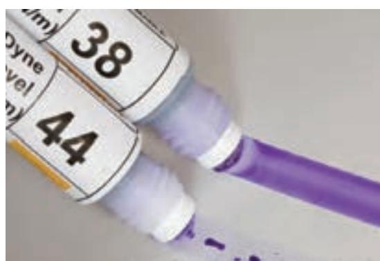
شکل ۳-۴۳ روش استفاده از مازیک تستر
