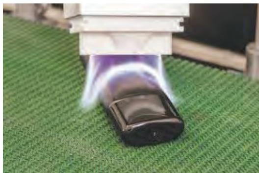
شکل ۳-۴۸ اثر روش کرونا بر روی سطح
