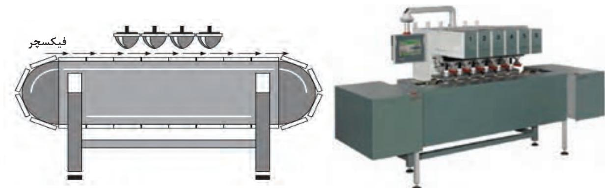
شکل ۳-۶۰ نوار نقاله خطی و نمای شماتیک آن
