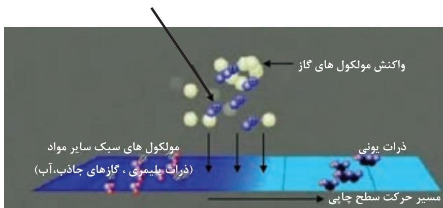
شکل ۳-۴۷ اثر روش گاز پلاسما بر روی سطح
