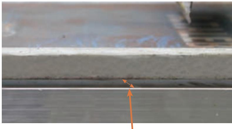
شکل ۵-۱۰ فاصله جداشیش شابلون از سطح زیرچاپ هنگام نمونه گیری
