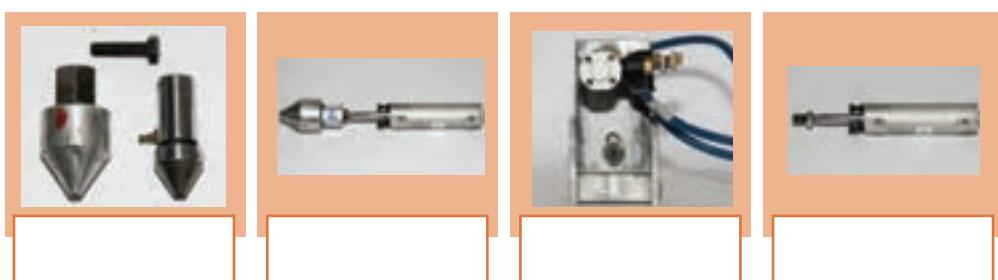
■ اندازه کلگی فوتک، متناسب با دهانه قطعه چاپ شونده می تواند به صورت کوچک و بزرگ انتخاب شود. (شکل ۵-۴۵)
