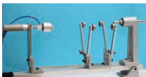
شکل ۵-۱۳ سیستم گرد زن جهت نمونه گیری بر سطوح استوانه‌ای
