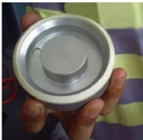
شکل ۴-۵۵ مخزن مرکب آهن رباي مرکزي
