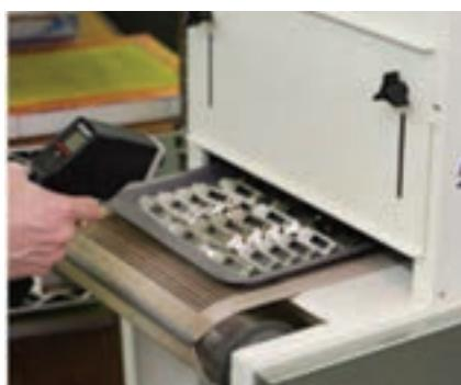
شکل ۳-۶۷ سنجش میزان حرارت خشک کن شکل
