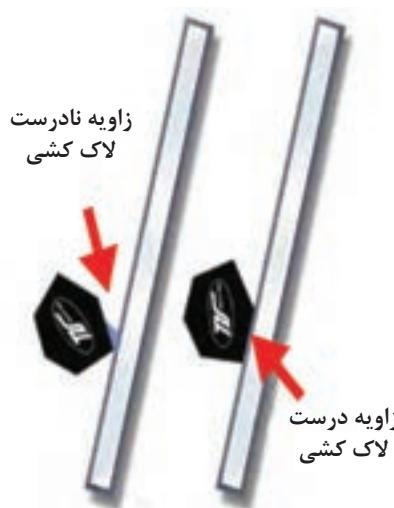
شکل ۱-۲ - الف - زاویه لاک کش دستی
