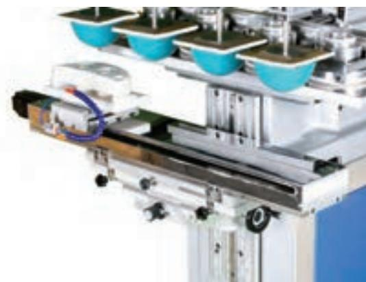
شاتل یک واژه انگلیسی به معنای انتقال دهنده است. در دستگاه‌های چند رنگ چاپ پد، برای انتقال سطح چاپ شونده از یک ایستگاه به ایستگاه بعد، نیاز است کار انتقال توسط مکانیزمی که شاتل نامیده می‌شود انجام گیرد. با توجه با این توضیح، متوجه می‌شویم که شاتل فقط در دستگاه‌های چاپ بیش از یک رنگ کاربرد داشته و بایستی از آن استفاده شود.
