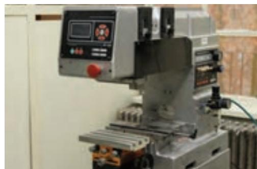
■ شکل نشان دهنده جای نصب کلیشه و سیستم مرکبدهی در سیستم مرکبدان باز یا بسته یک دستگاه چاپ بالشتکی است.
