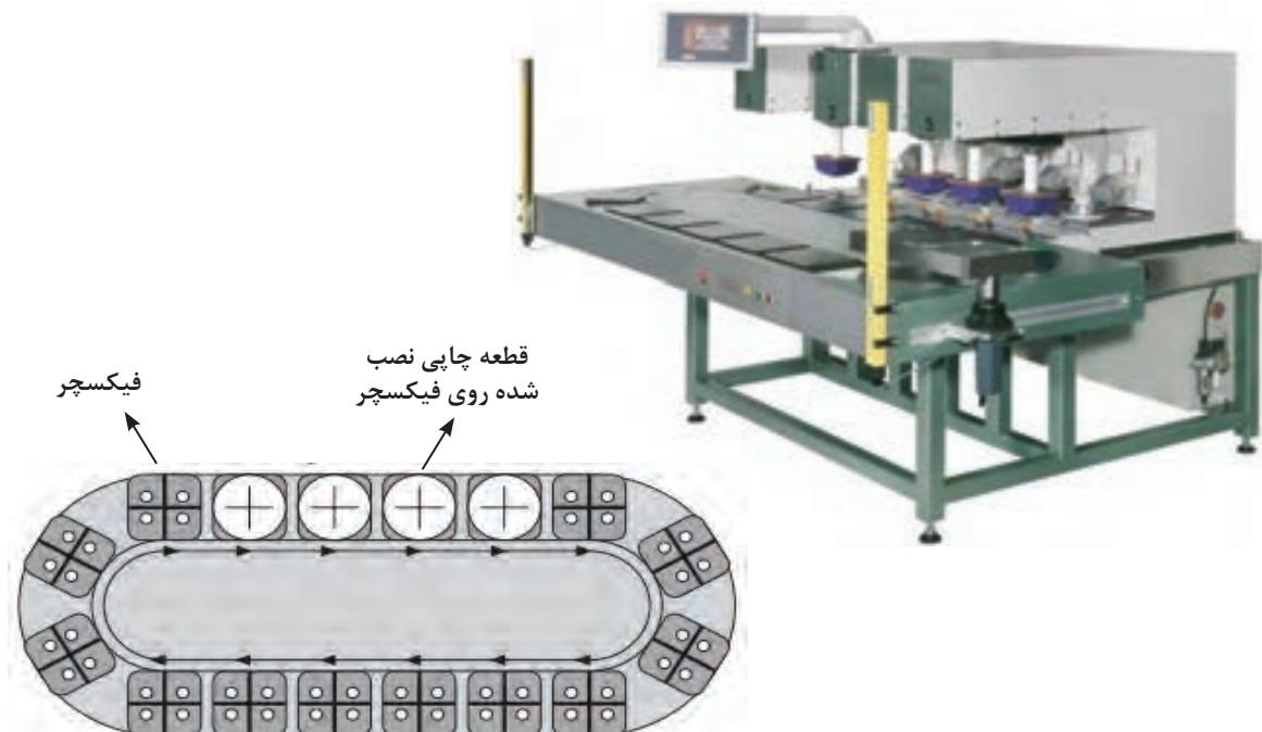
شکل ۳-۶۱ نوار نقاله چرخشی و نمای شماتیک آن
