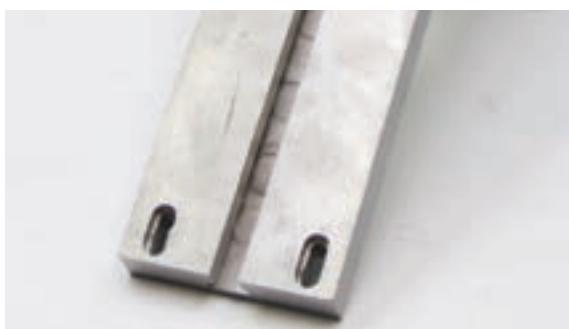
شکل ۵-۲۷-قالب های شیاردار
