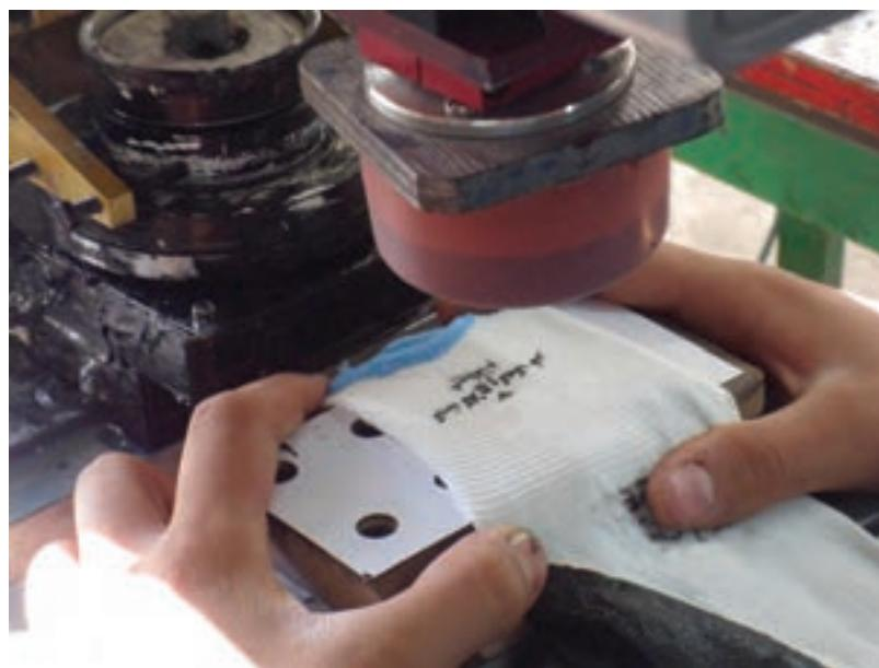
شکل ۳-۳۷ چاپ یک دستکش کار به روش بالشتکی
