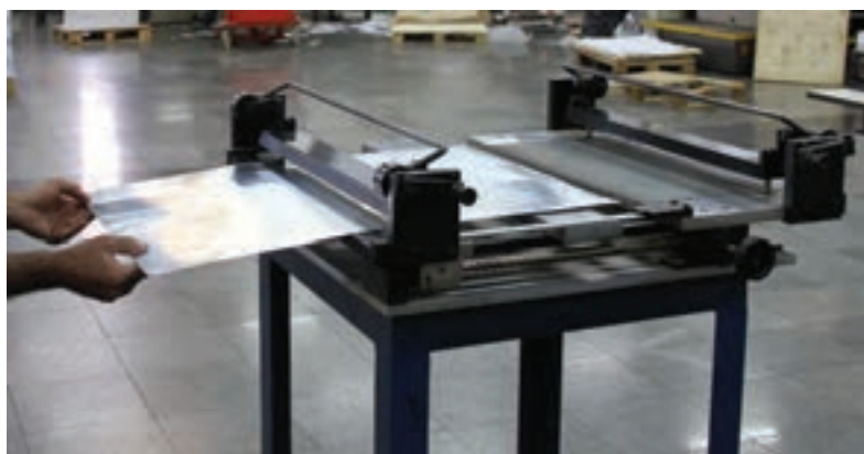
شکل ۶۲- قرار دادن پلیت در دستگاه خم‌کن
