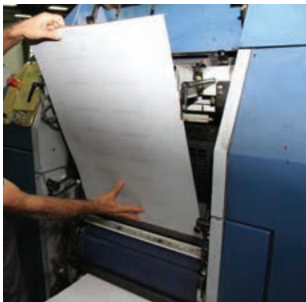
شکل ۶۹- قرار دادن لب کار در شیار سیلندر
