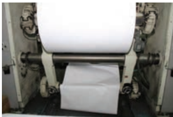
شکل ۱۱- ته رول خارج شده از تغذیه
