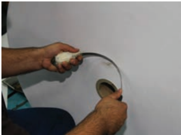
شکل ۵- برطرف کردن آسیب روی بدنه رول
