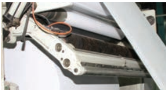
شکل ۱۰- اجزای سیستم اسپلیسر
