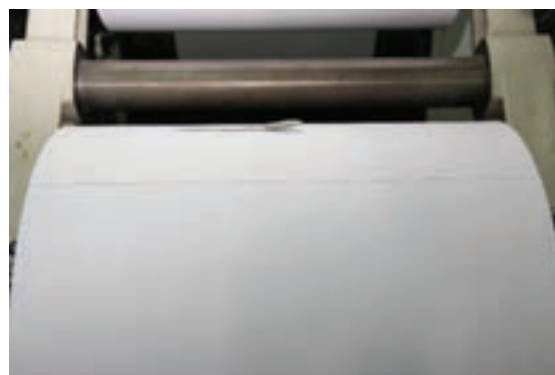
شکل ۱۸- لبه گونیا شده رول
