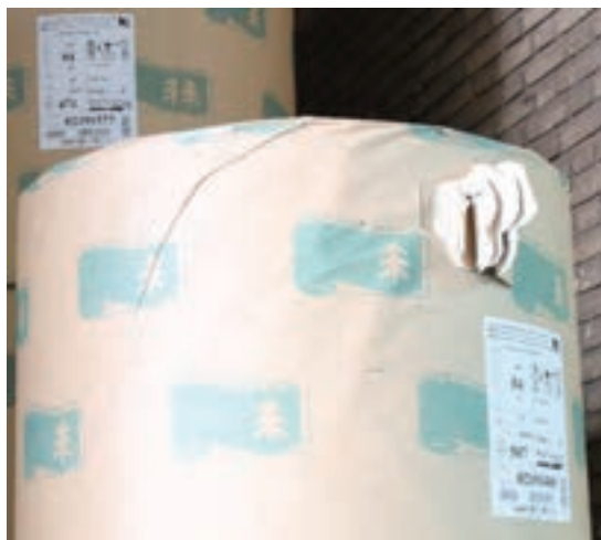
شکل ۶- خراش و پارگی روی بدنه رول
