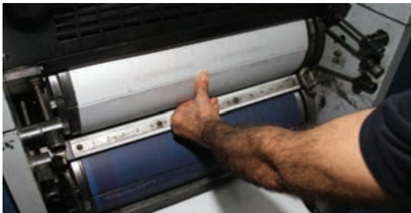
شکل ۷۱- قرارگیری ته کار پلیت در شیار سیلندر
