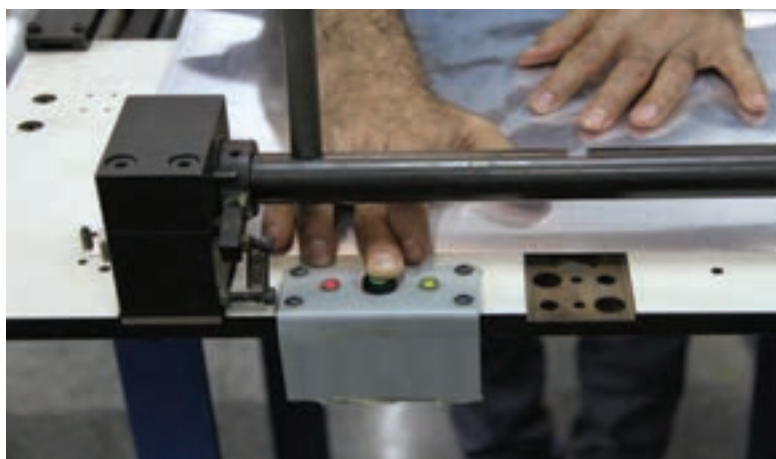
شکل ۶۰- حسگرهای لب کار پلیت
