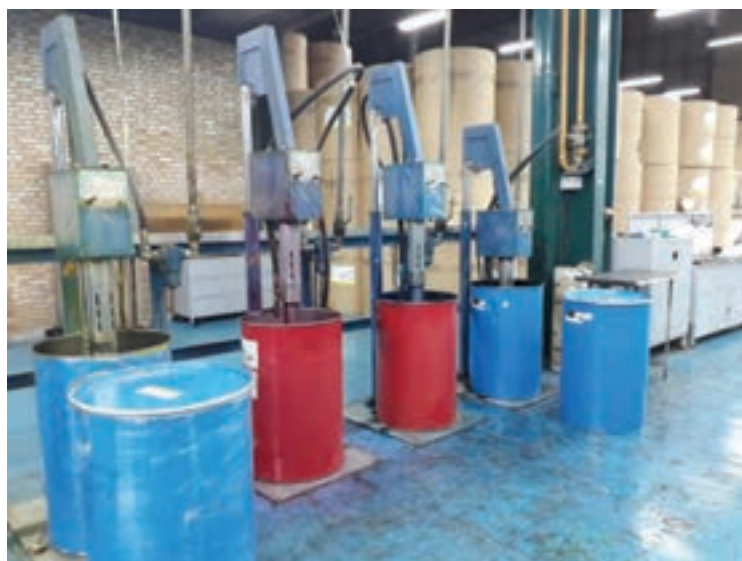
شکل ۷۷- مکانیزم تغذیه خودکار مرکب
