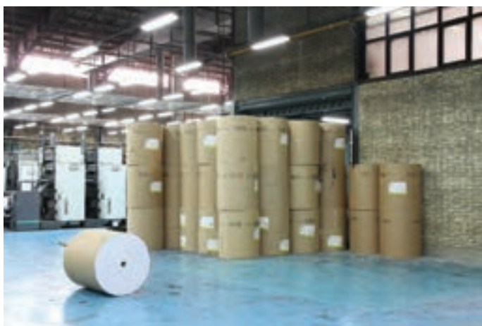
شکل ۱- حالت درست قرار گرفتن رول‌های کاغذ
