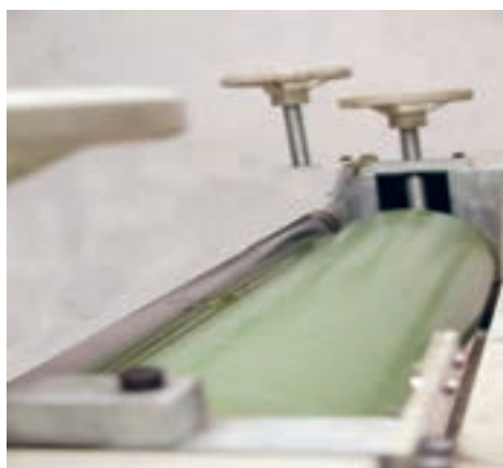
شکل ۱۵- سیستم نوردی ورنی زنی و پیچ های تنظیم تماس نورد کرومی به لاستیک
