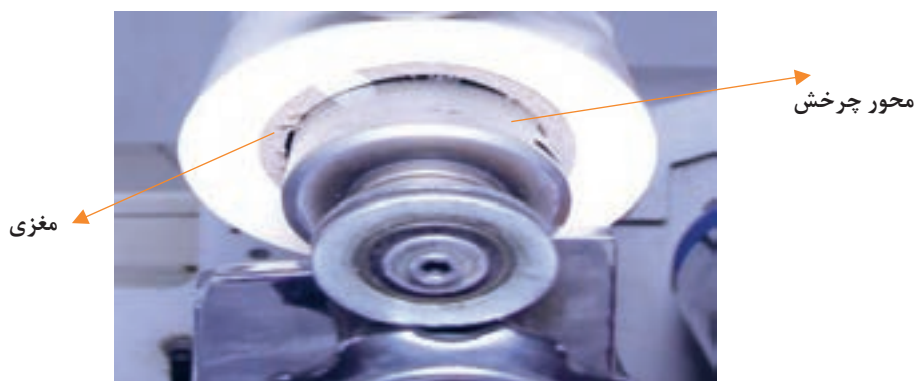
شکل ۲۹- تناسب مغزی سلفون با محور چرخشی دستگاه
