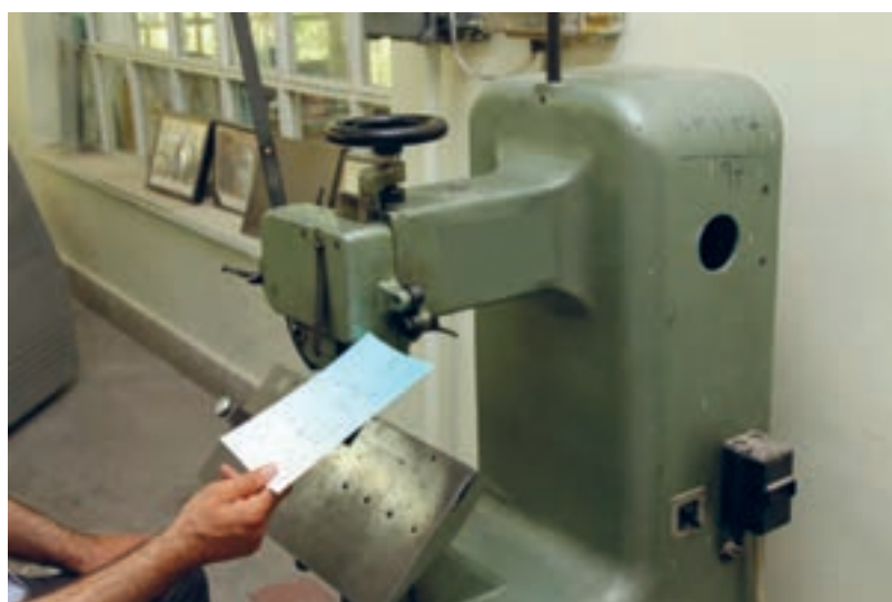
شکل ۳۸- تنظیم‌کننده ضخامت بلوک و طول مفتول
