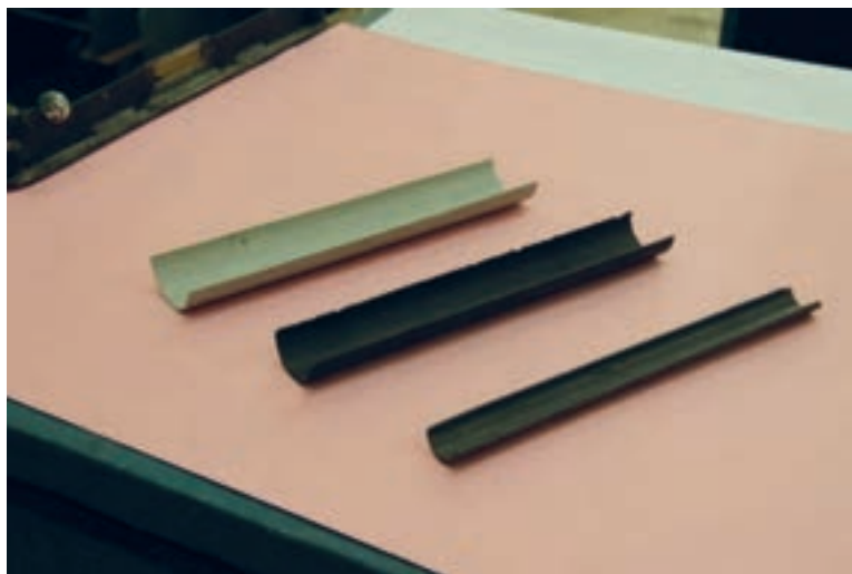
شکل ۱۲- قالب‌های نیمه استوانه‌ای جهت گرد کردن
