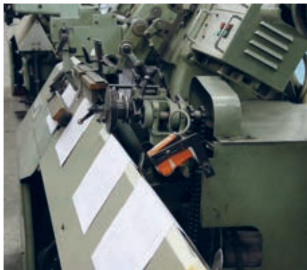
شکل ۲۴- صفحه انتقال دهنده فرم و قطعات آن
