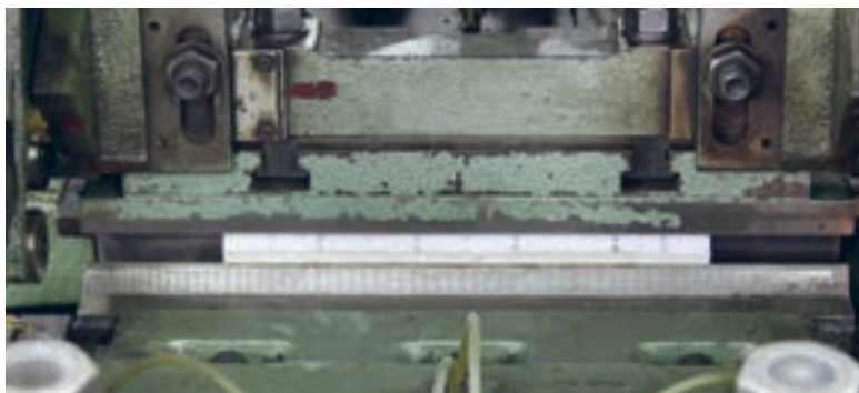
شکل ۵۹- عمل ته‌کوبی عطف بلوک توسط قالب
