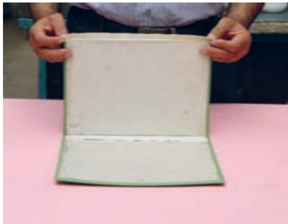
شکل ۴۴- برگرداندن دورتادور پوشش به داخل جلد
