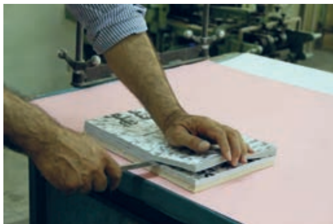
شکل ۱۴- جدا کردن بلوک‌ها از یکدیگر
