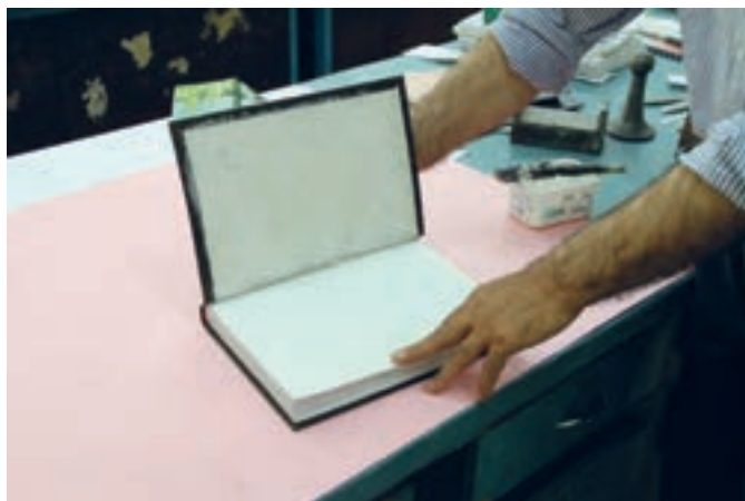
شکل ۵۶- تلفیق جلد و بلوک
