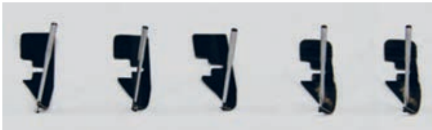
شکل ۳۱- تیغه‌های برش دستگاه دوخت
