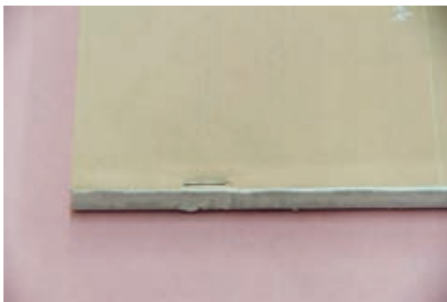
شکل ۱۶- رعایت فاصله مناسب مفتول تا انتهای عطف
