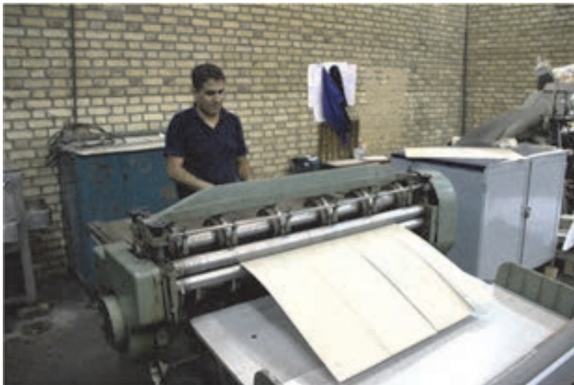
شکل ۴۶- برش لتهای جلد با دستگاه مقوایر
