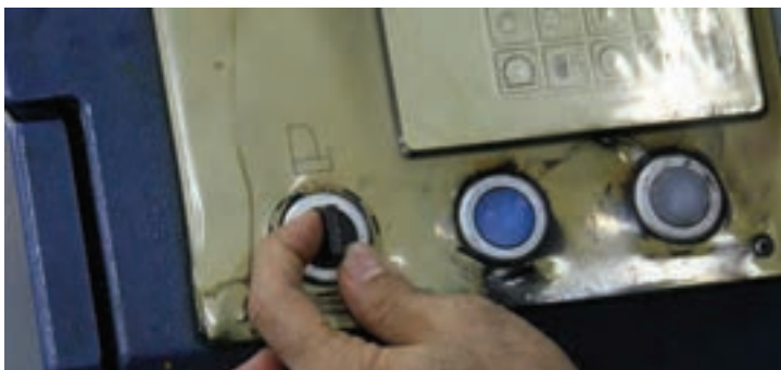
شکل ۵۲- کلید آزاد کردن سیلندرها
