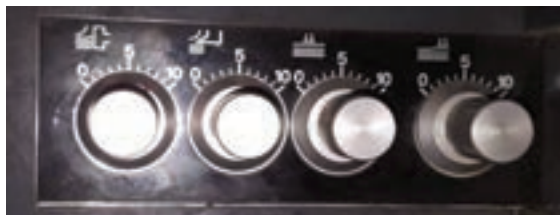
شکل ۱۹- شیرهای تنظیم باد
