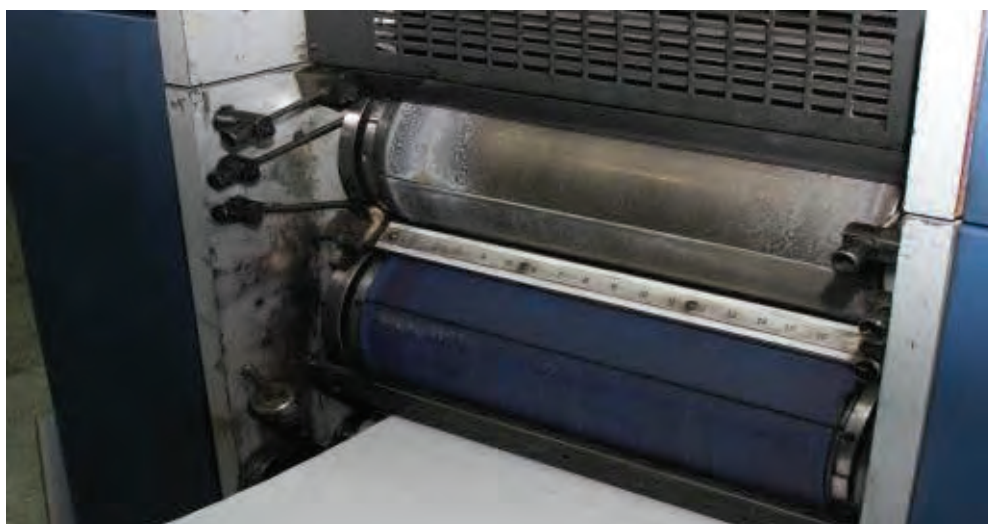
شکل ۶۸- سیلندر آماده بستن پلیت
