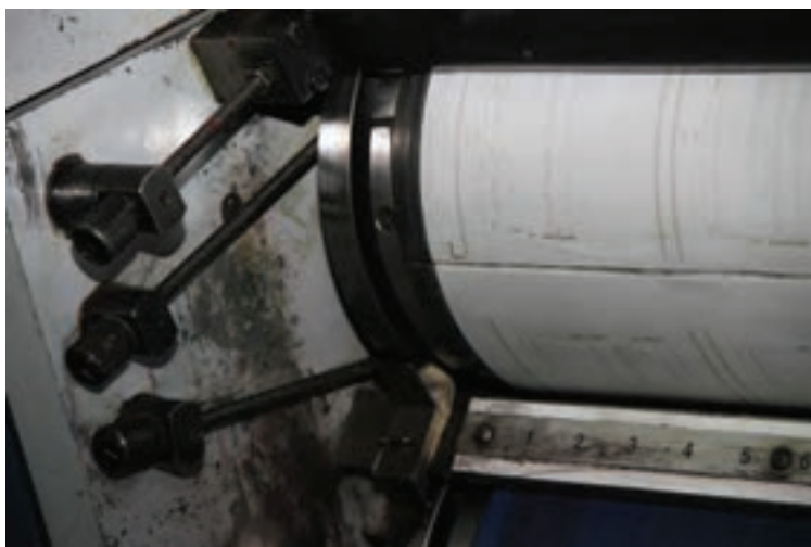
شکل ۵۳- شیار سیلندر (لبه‌های پلیت)
