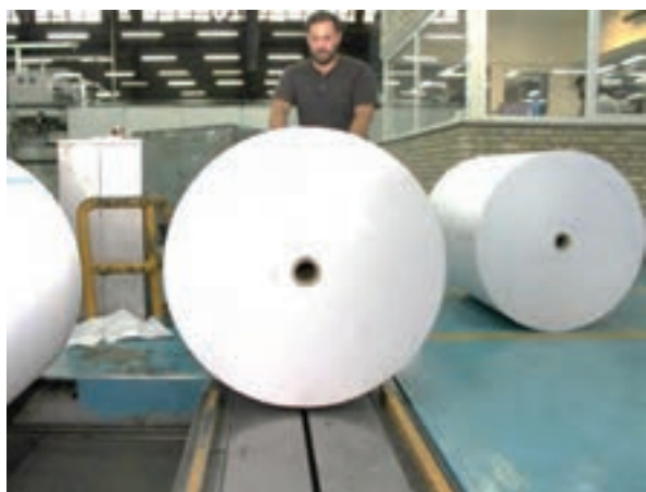
شکل ۱۵- انتقال رول از ریل به روی واگن
