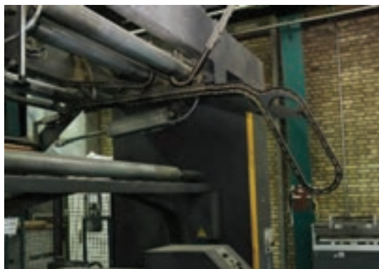
شکل ۲۶- سیستم کاغذ کشی زنجیری
