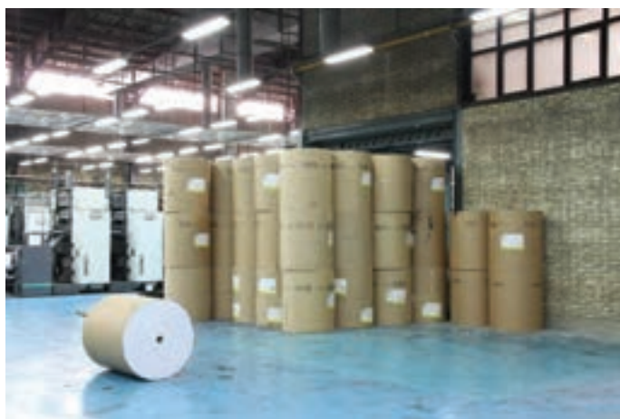
شکل ۱- حالت درست قرار گرفتن رول‌های کاغذ
