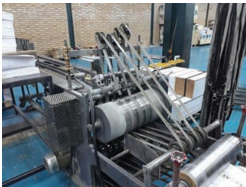
شکل ۴۸- سیلندر پرس و دسته کن (Stacker)
