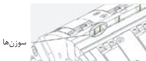
شکل ۳۸- سوزن‌های روی سیلندر
