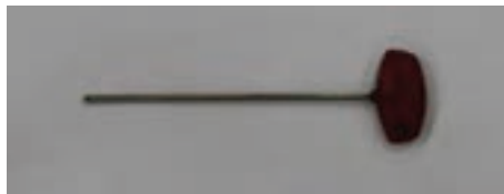
شکل ۵۱- آچار مخصوص باز کردن پلیت
