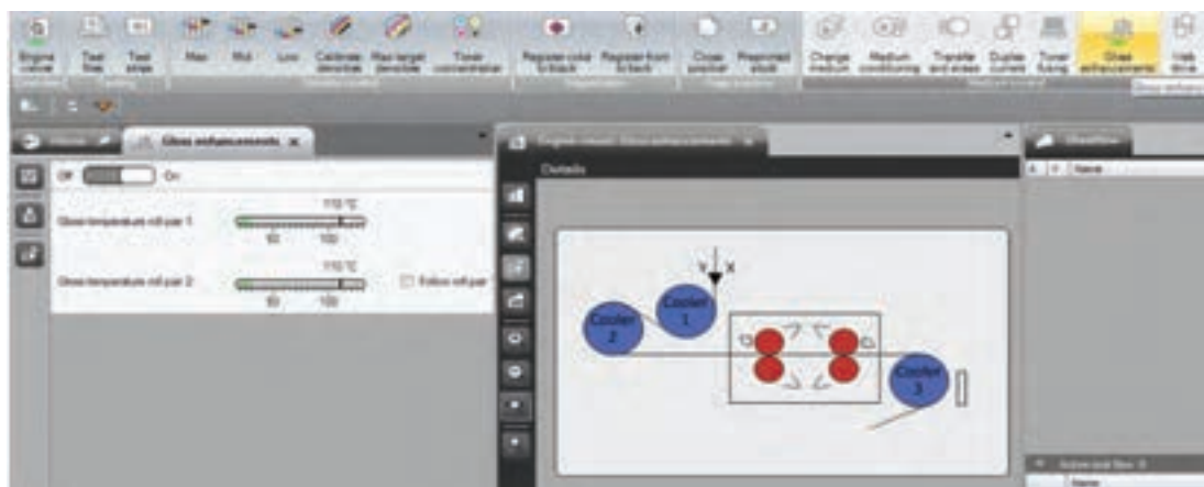
شکل ۲۳- تنظیم دمای فیوزر
