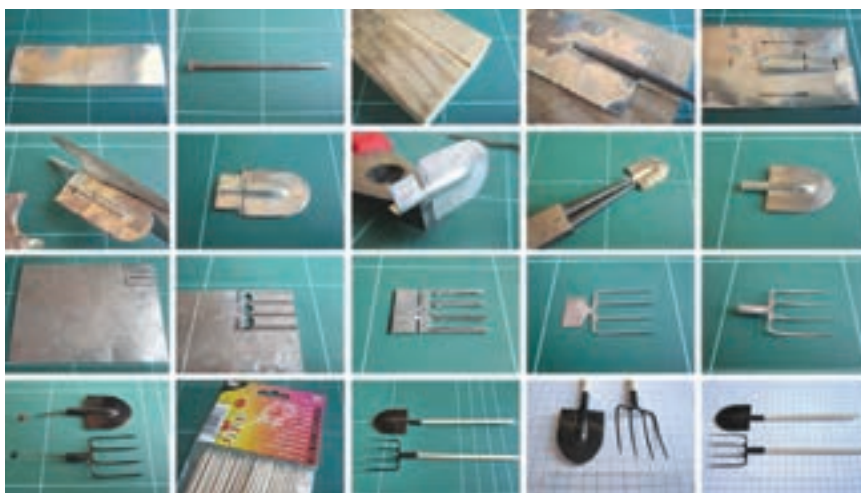
ابزار کشاورزی ساخته شده توسط ورقه فلزی
