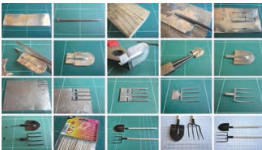
ابزار کشاورزی ساخته شده توسط ورقه فلزی
