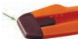
شکل ۱-۹- شکاف موجود در قطعه انتهایی دسته کاتر
