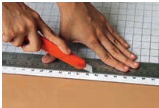
شکل ۴۰-۱- روش برش لبه اضافی کاغذ با کاتر
