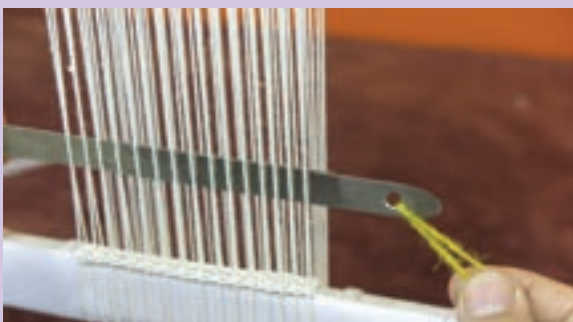
روش های صحیح در دست گرفتن سیخ پودکشی و حرکت آن
