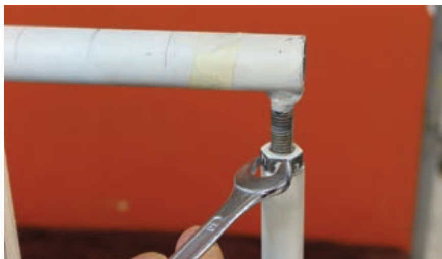
تصویر ۲-۲۹ ▲ سفت کردن مجدد پیچ‌های سر دار
