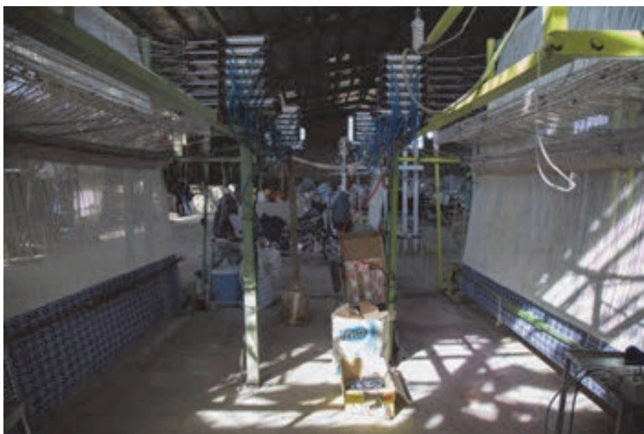
شکل ۲۷- دستگاه مکانیکی بافت زیلو
