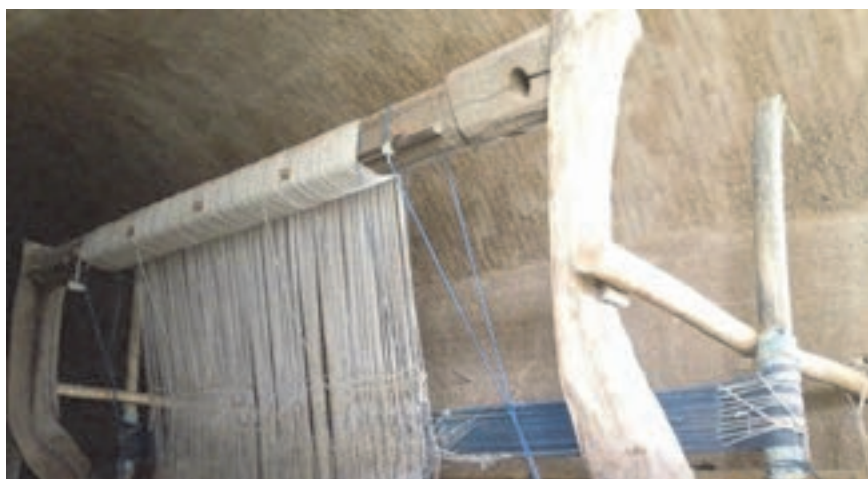
شکل ۳۰- تیر بالا در دستگاه زیلوبافی
