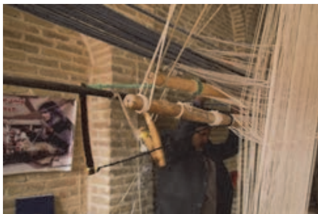
شکل ۳۳- شمشه‌ها در دستگاه زیلوبافی
