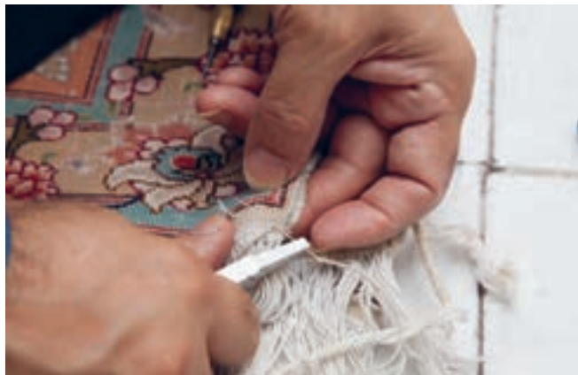
تصویر ۴۹- مراحل اتصال قیطان به لبه قالی ▲
