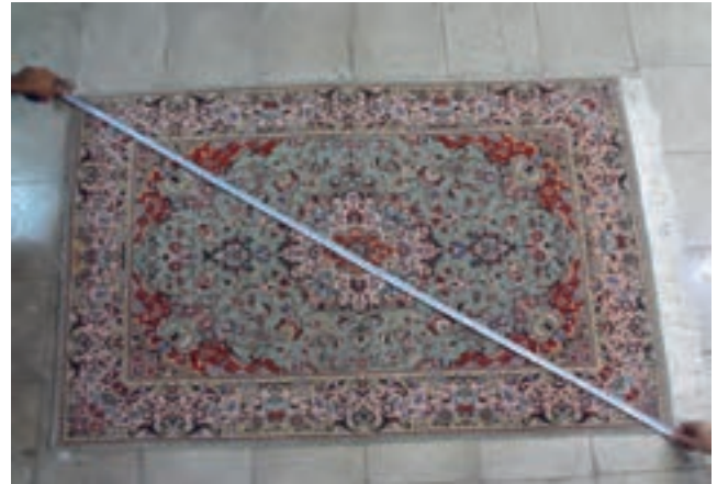
تصویر ۹- اندازه‌گیری قطرهای قالی با متر ▲
