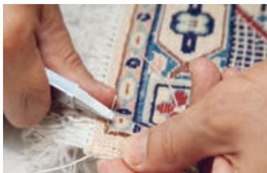
▲ تصویر ۴۵ - تنظیم کشش نخ هنگام دوخت
