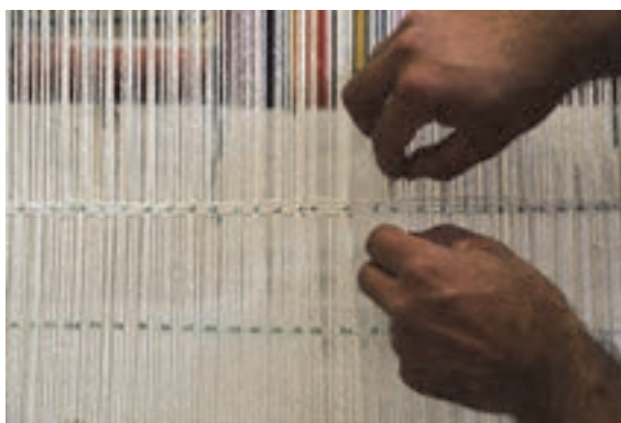
شکل ۷۲- مرتب کردن و تنظیم فاصله چله‌ها
