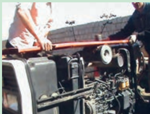
شکل ۴۰. برداشتن کاپوت تراکتور MF۳۹۹
