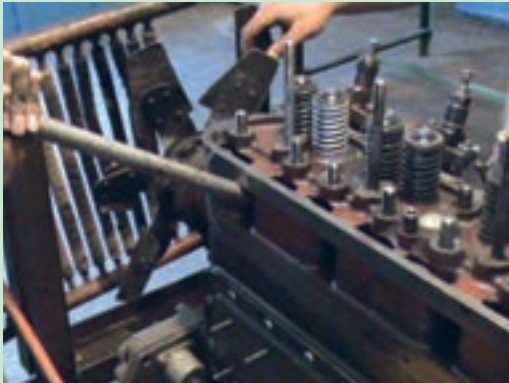
شکل ۴۹. آزاد کردن چسبیدگی سر سیلندر
