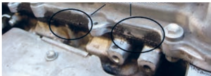
شکل ۲۷. نشستی روغن از درپوش سوپاپ‌ها
