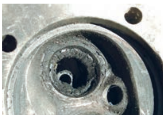
شکل ۶۷. کربن گرفتگی سرسیلندر و سوپاپ‌ها
