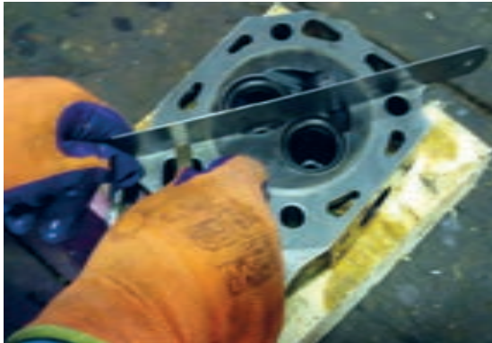
شکل ۶۵. کنترل تابیدگی سرسیلندر تراکتور دوچرخ
