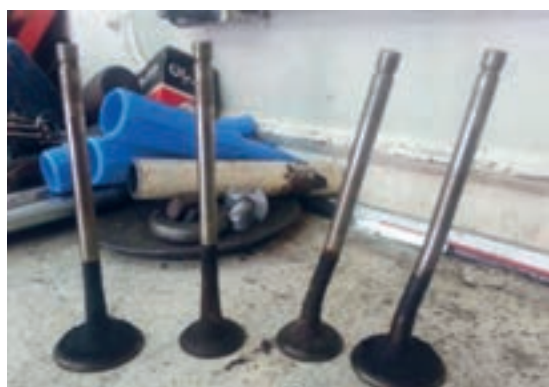
شکل ۶۷. کربن گرفتگی سرسیلندر و سوپاپ‌ها
