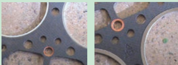
شکل ۸۷. تفاوت ضخامت قسمت‌های مسی روی واشر سرسیلندر
