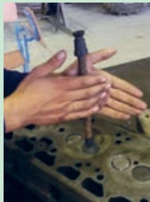
شکل ۷۹. چرخاندن سوپاپ به وسیله چوب سوپاپ گردان
