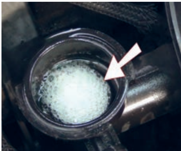
شکل ۳۳. خروج حباب از رادیاتور
