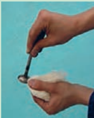
شکل ۸۰. تمیز کردن سوپاپ
