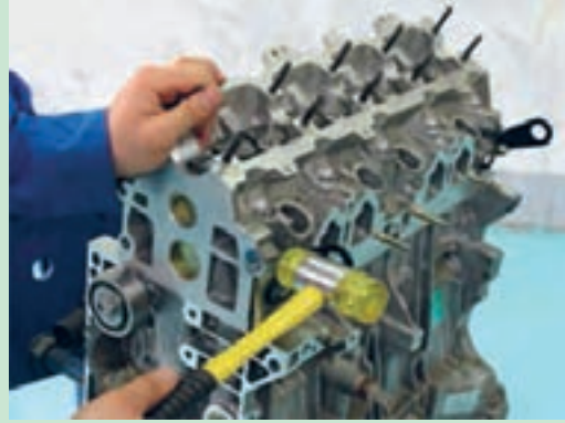
شکل ۴۹. آزاد کردن چسبیدگی سر سیلندر
