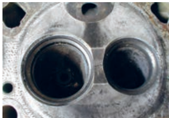
شکل ۶۶. ترک خوردگی سرسیلندر در محفظه احتراق
