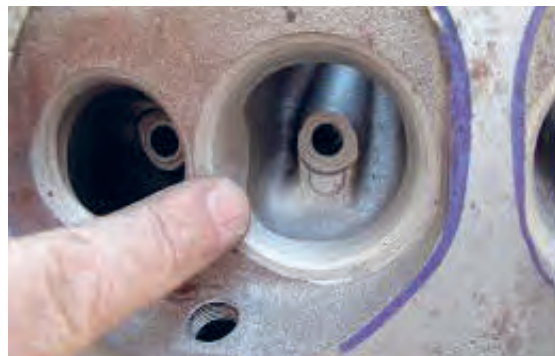
شکل ۱۵. سیت سوپاپ و زوایای لبه سوپاپ در محل نشستن بر روی سیت
