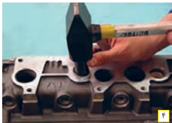
شکل ۶۹. روش تعویض پولک سر سیلندر
