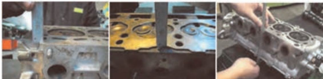
شکل ۸۳. کنترل ارتفاع مجاز کف تراشی سر سیلندر
