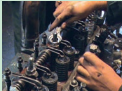
شکل ۴۵. باز کردن پیچ‌های پایه اسبک
