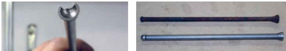
شکل ۷۶. زنگ زدن و شکستگی میل تپت
