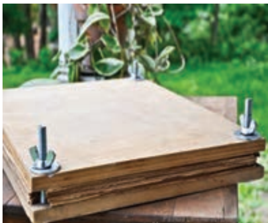
شکل ۱۷- تخته پرس مخصوص خشک کردن نمونه‌های گیاهی
