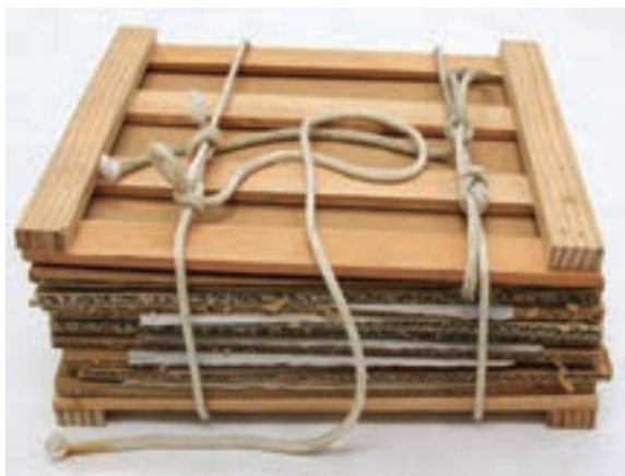
شکل ۱۷- تخته پرس مخصوص خشک کردن نمونه‌های گیاهی
