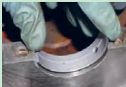
شکل ۸۵. نصب یاتاقان ها روی تکیه گاه های میل لنگ و کپه ها
