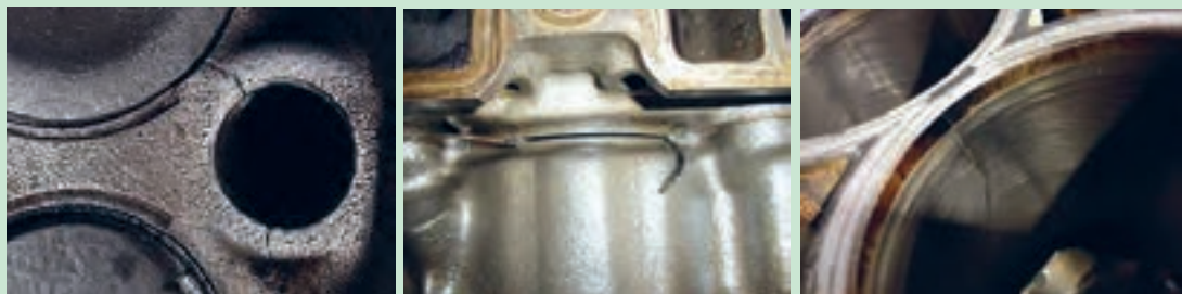
شکل ۶۲. ترک در سیلندر و بلوکه سیلندر
