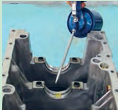
شکل ۹۵. روغنکاری یاتاقان ها قبل از نصب
