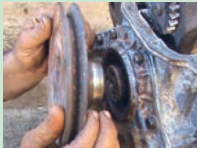
شکل ۳۵. پیاده کردن پولی میل لنگ
