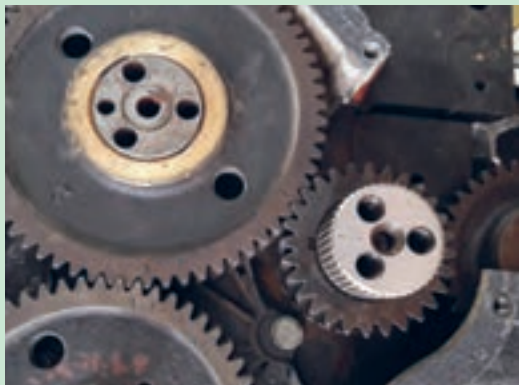
شکل ۱۰۹. علامت‌های تایمینگ روی چرخ دنده ها
