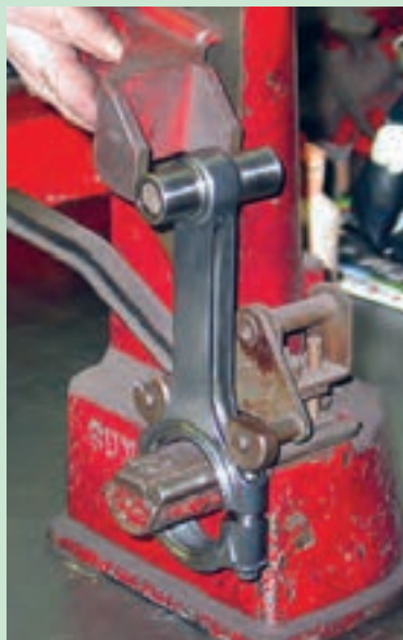
شکل ۸۲. پیچیدگی شاتون، اندازه گیری و اصلاح آن
