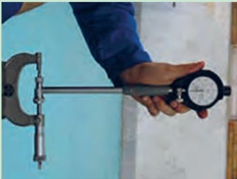
شکل ۶۳. کنترل دو په‌نی تکیه‌گاه‌های میل‌لنگ
