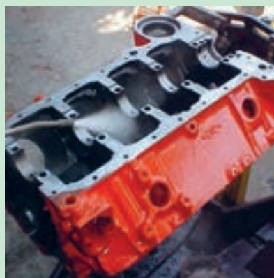
شکل ۵۶. تمیز کردن قطعات با فشار آب گرم و مواد پاک کننده
