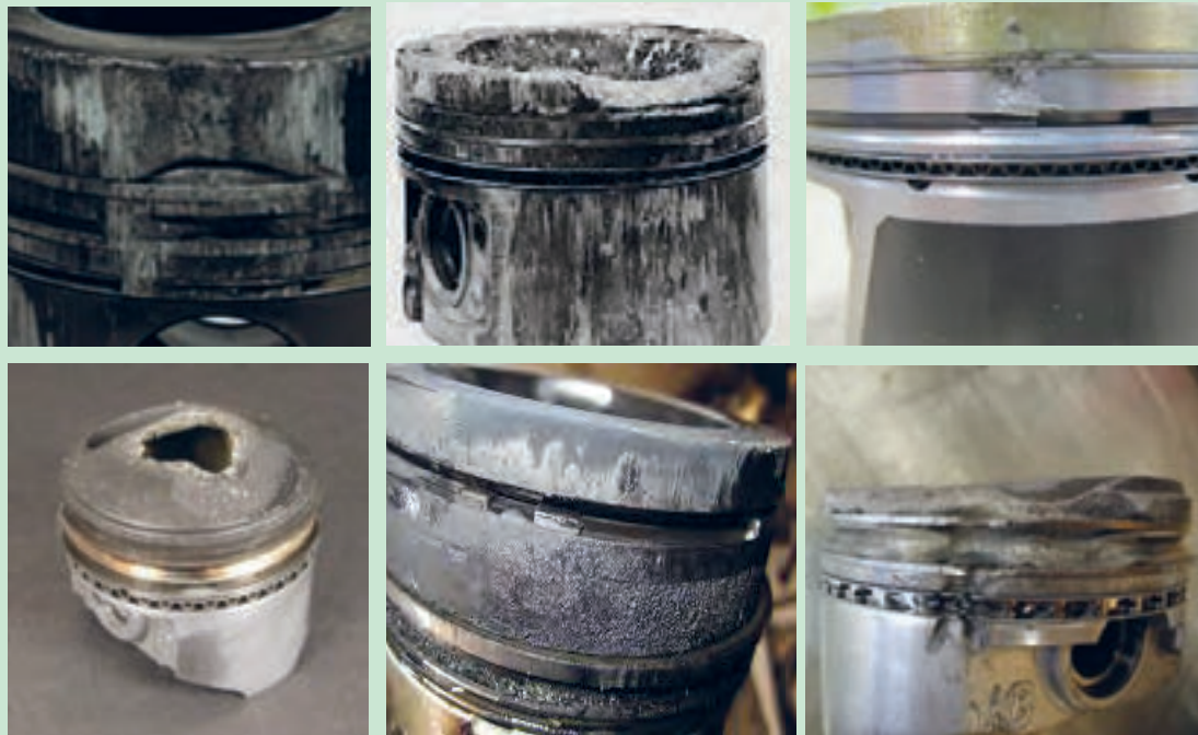
شکل ۷۴. نمونه ای از پیستون های معیوب
