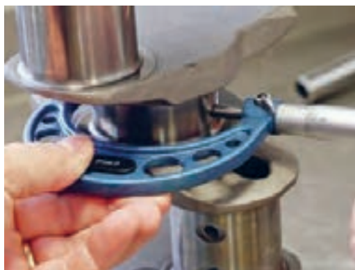
شکل ۷۱. اندازه‌گیری قطر میل‌لنگ
