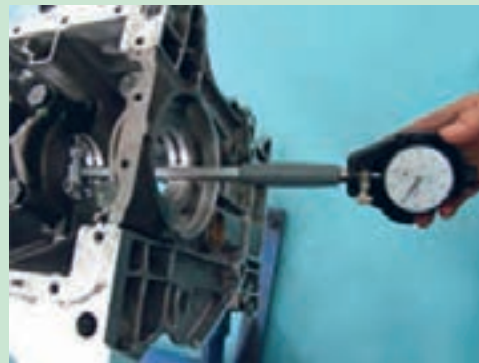
شکل ۶۳. کنترل دو په‌نی تکیه‌گاه‌های میل‌لنگ
