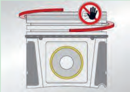
شکل ۵۳. خارج کردن رینگ بدون رینگ بازکن
