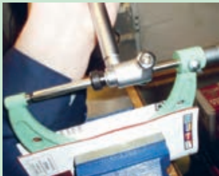
شکل ۷۶. اندازه‌گیری قطر سیلندر با میکرومتر داخلی
