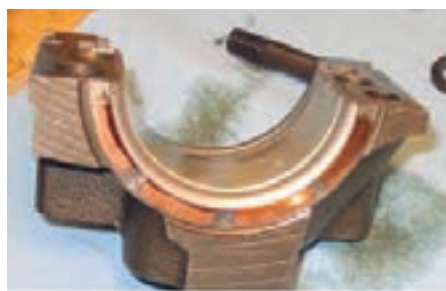
شکل ۷۳. نمونه بغل یاتاقانی معیوب
