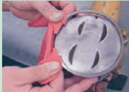
شکل ۵۳. خارج کردن رینگ بدون رینگ بازکن
