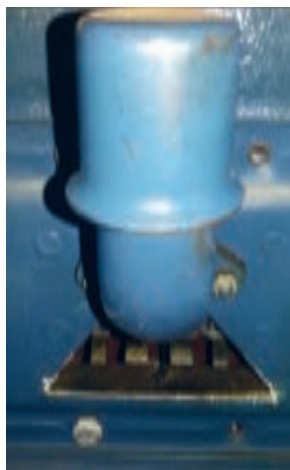
شکل ۴۰. تهویه محفظه کارتر در تراکتور U650
