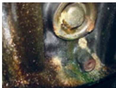
شکل ۷. نشتی از پولکی های موتور
