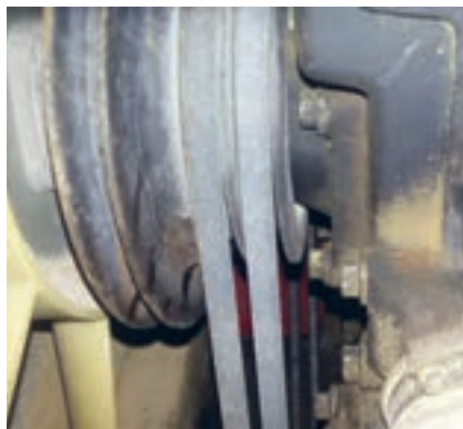
شکل ۷. استفاده از دو تسمه در تراکتور MF۳۹۹
