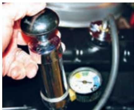
شکل ۶. آزمایش نشت یابی تحت فشار
