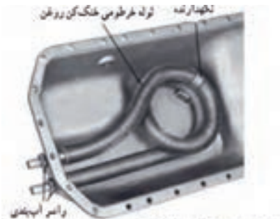
الف- عبور لوله مایع خنک‌کننده از کارتر ب- عبور مایع خنک‌کننده از پایه فیلتر JD۳۱۴ ج- رادیاتور روغن U۶۵ شکل ۴۶. انواع خنک‌کن روغن رایج در تراکتورها
