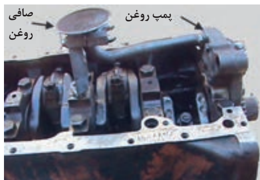
شکل ۴۱. پمپ روغن موتور و صافی آن
