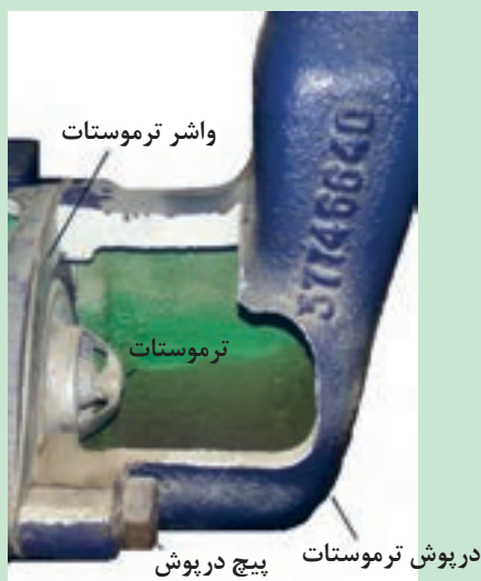
شکل ۱۷. نمای برش خورده ترموستات تراکتور MF۲۸۵
