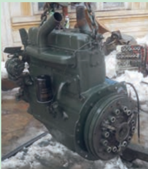
شکل ۲۴. پیاده کردن موتور تراکتور U650
