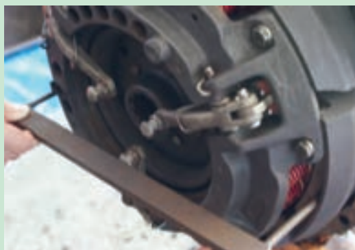
شکل ۳۸. تنظیم انگشتی‌های کلاچ
