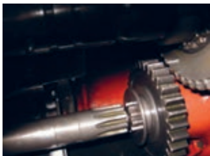
شکل ۲۰. محور تواندهی در حالت خلاص
