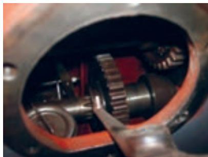
شکل ۲۱. محور تواندهی در حالت موتور گرد
