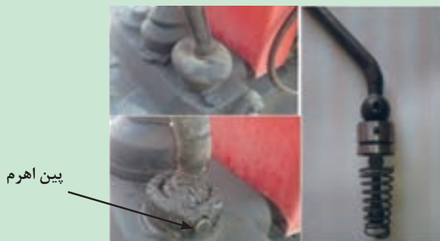
شکل ۲۹. خارج کردن اهرم‌های تعویض دنده
