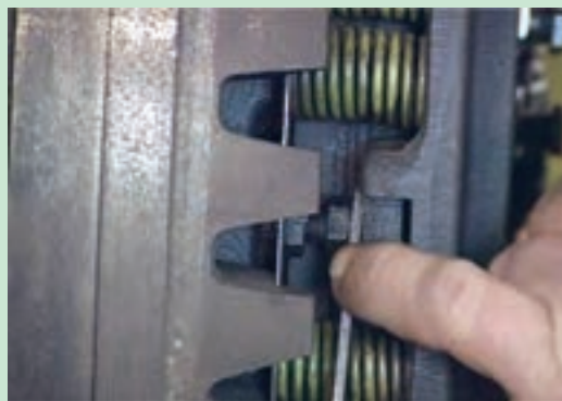
شکل ۳۹. تنظیم کلاچ محور تواندهی
