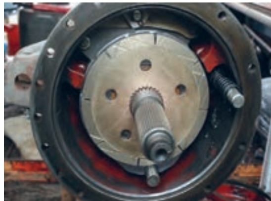
شکل ۳. بین‌های نگهدارنده مکانیسم ترمز
