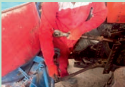
شکل ۱۰- اتصال بازوی وسط تراکتور به بذرپاش
