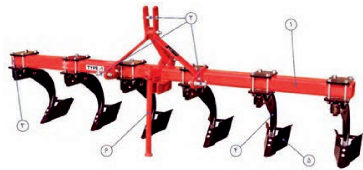
شکل ۱۳- ساختمان شیارکش
