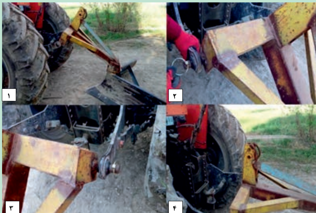
شكل ۲۲- روش اتصال نهركن به تراكتور
