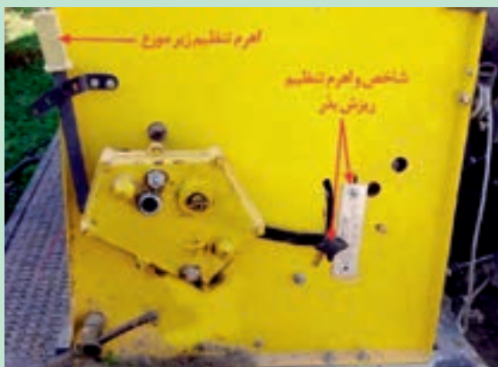
شکل ۱۷- اهرم تنظیم ریزش بذر
