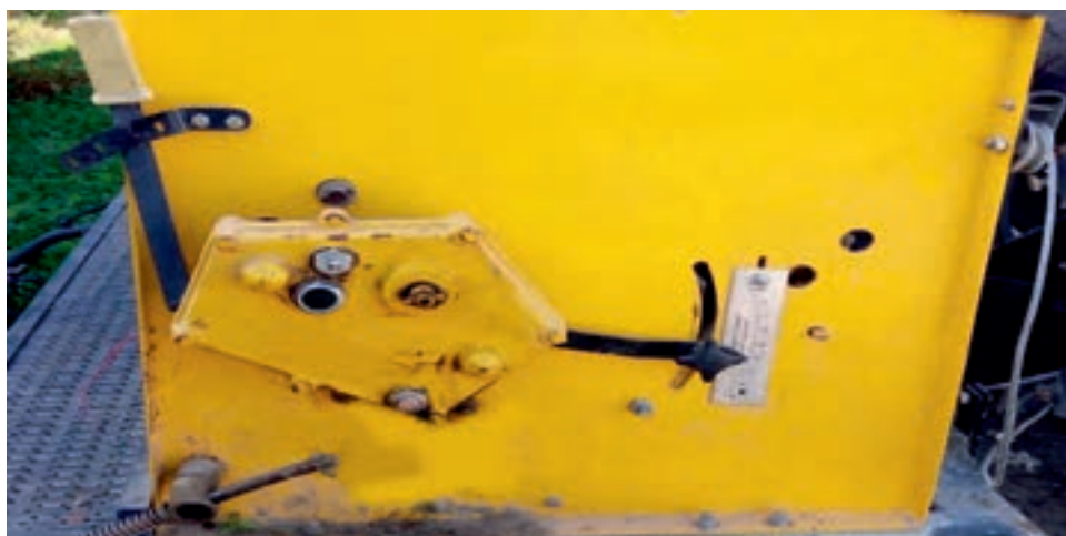
شکل ۱۵- جعبه دنده و درجه ریزش بذر
