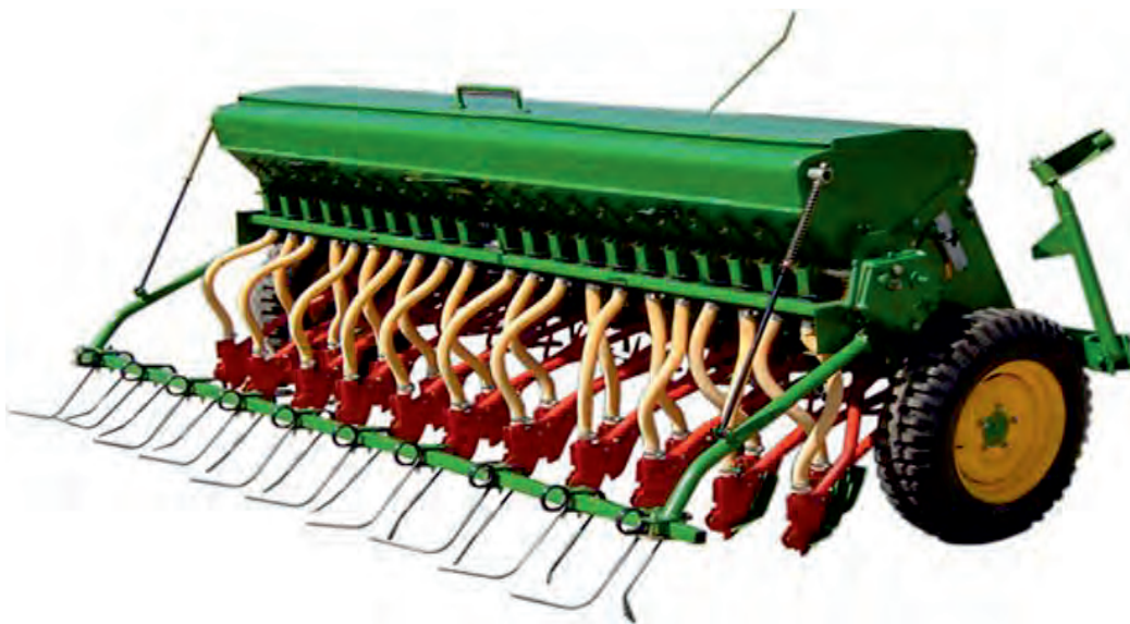
شکل ۳- خطی کار مجهز به دندانه فنی
