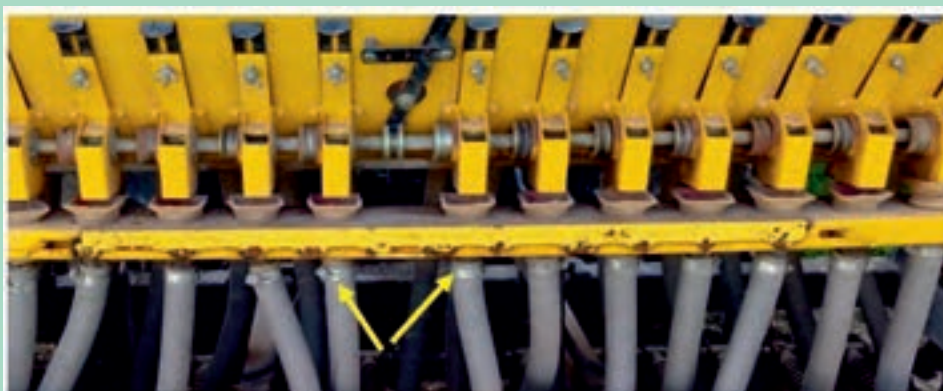
شکل ۲۸- بست‌های نگهدارنده لوله‌های سقوط
