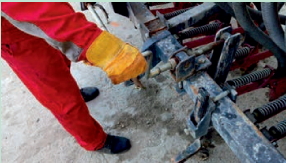
شکل ۲۱- تنظیم عمق کاشت
