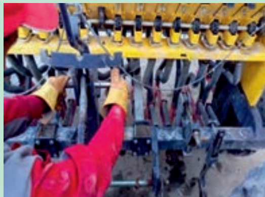
شکل ۱۳- متصل کردن خطی کار به تراکتور
