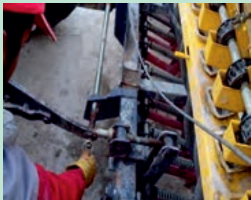
شکل ۱۳- متصل کردن خطی کار به تراکتور
