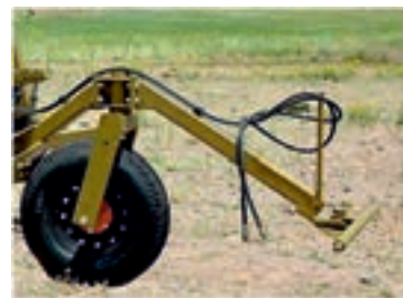
شکل ۴۹- ماشین دیم کار کششی با تک تقطه اتصال و شیلنگ های هیدرولیک
