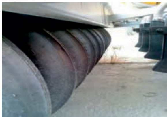
شکل ۵۵- چرخ‌های فشار دهنده بوشورت به هم پیوسته
