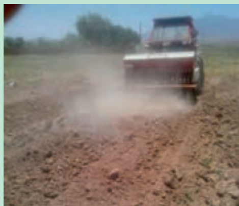
شکل ۶۰- کاشت با ماشین عمیق‌کار دیم
