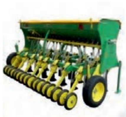
شکل ۳۳- نمونه ماشین کاشت مستقیم مکانیکی مناسب جهت کشت دیم مدل rock/3000
