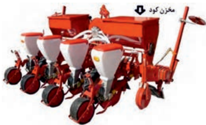
شکل ۱۰- ساختمان یک پنوماتیک با کودکار
