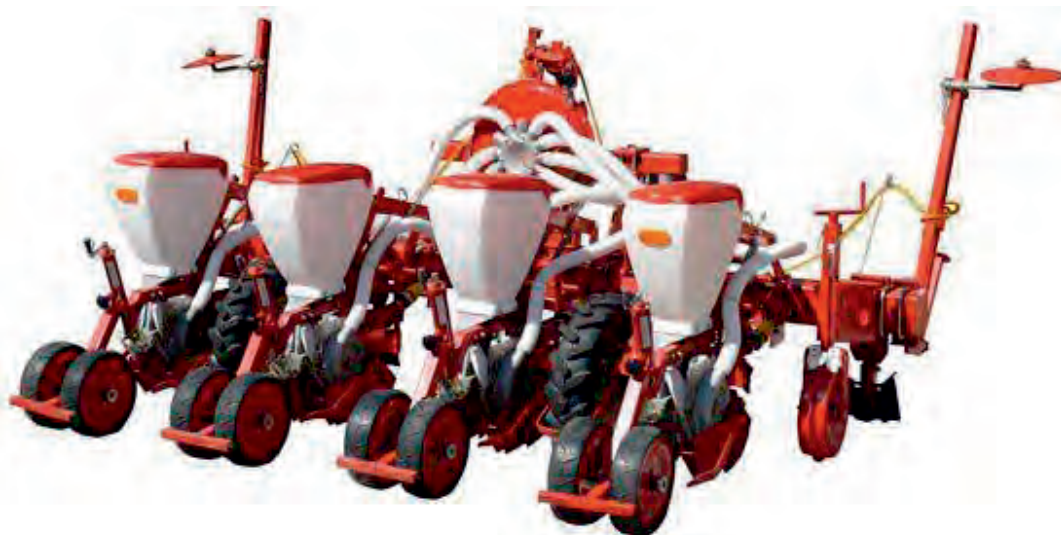
شکل ۳- ردیف‌کار پنوماتیکی تک‌دانه‌کار دوخط روی پشته
