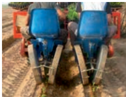
شکل ۳۸ - نشاکار نیمه خودکار
