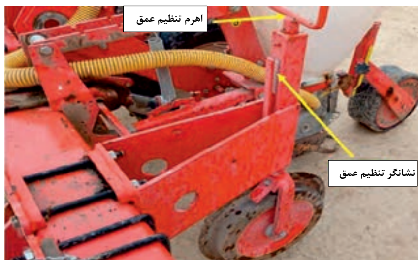
شکل ۱۸- تنظیم عمق کاشت
