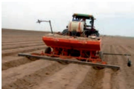
شکل ۳۳- غده‌کار تمام خودکار دو ردیفه
