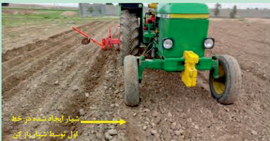
شکل ۲۸- عملیات کاشت در حالت برگشت
