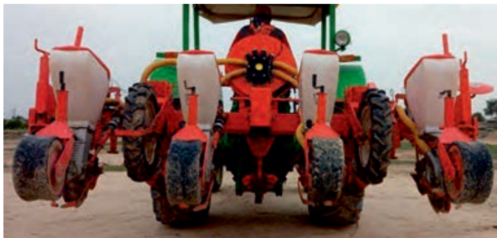
شکل ۴- ردیف‌کار پنوماتیکی تک‌دانه‌کار یک‌خط روی پشته
