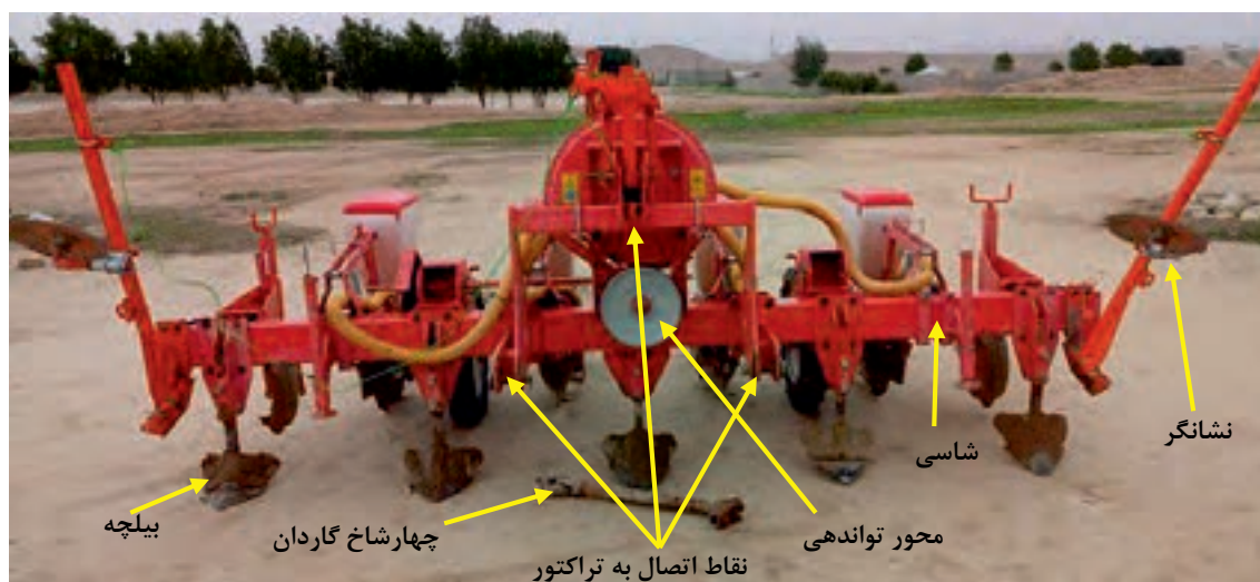
شکل ۶- ساختمان ردیف‌کار پنوماتیکی بدون کودکار از جلو دستگاه
