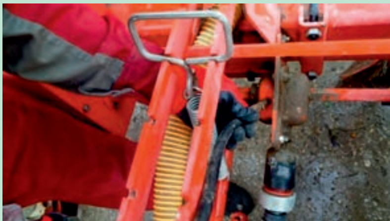
شکل ۱۲- گریس‌کاری تمام گریس‌خوره‌های ماشین ردیف‌کار
