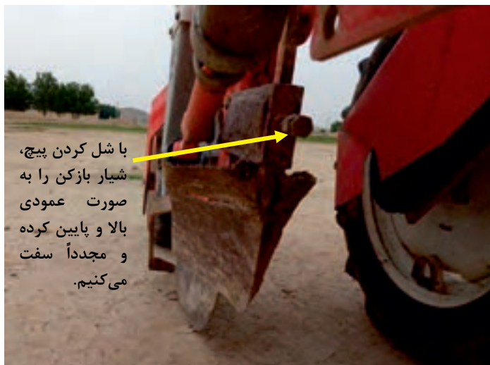
شکل ۲۰- تنظیم شیار بازکن
