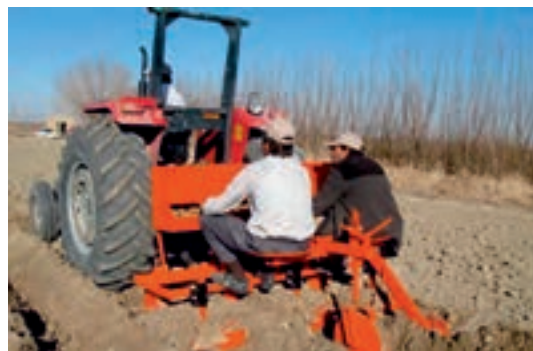
شکل ۳۲- غده‌کار نیمه خودکار دو ردیفه
