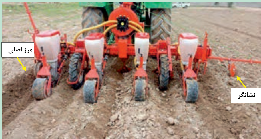
شکل ۲۷- کاشت بذر با ردیف‌کار پنوماتیکی
