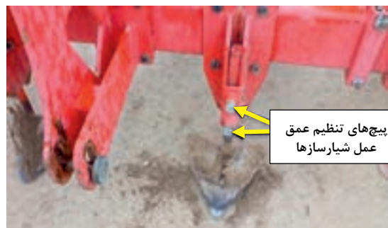
شکل ۱۷ - پیچ‌های تنظیم عمق شیارساز
