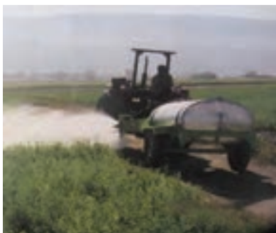
شکل ۶۳- نمونه هایی از سمپاش‌های توربولاینر ثابت و پشت تراکتوری
