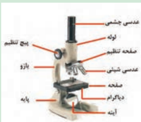
شکل ۲۳- اجزای مختلف نوعی میکروسکوپ
