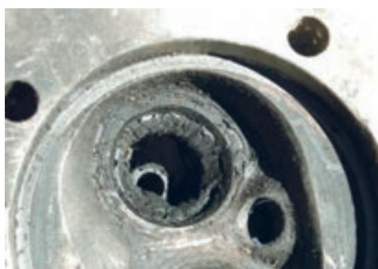
شکل ۶۷. کربن گرفتگی سرسیلندر و سوپاپ‌ها
