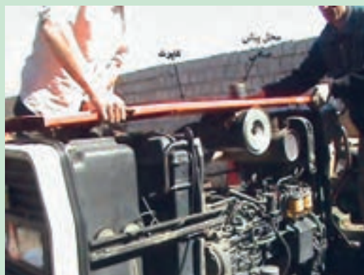
شکل ۴۰. برداشتن کاپوت تراکتور MF۳۹۹
