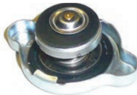
شکل ۱۲. درب رادیاتور و سوپاپ های آن
