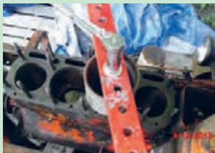
شکل ۹۰. جا زدن بوش با ابزار
