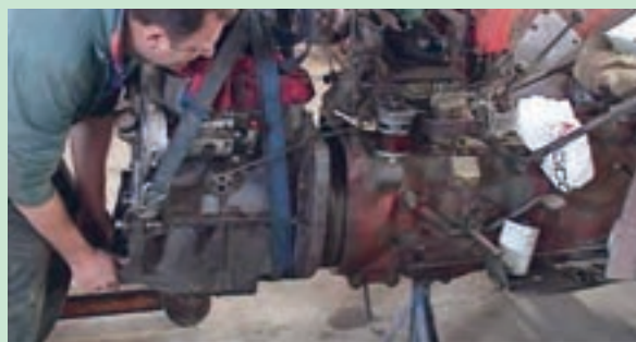
شکل ۳۲. جدا کردن موتور از جعبه دنده
