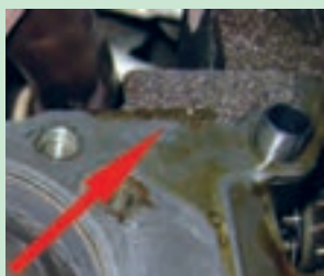
شکل ۶۷. پین روی بلوکه سیلندر
