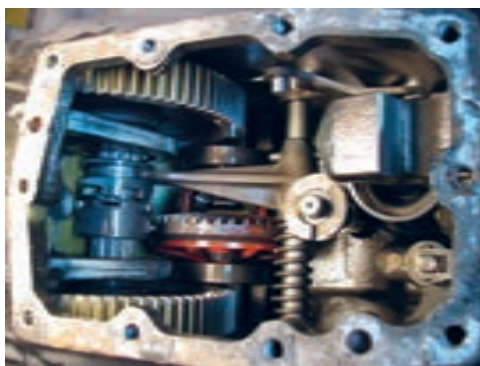
شکل ۱۷. قفل دیفرانسیل
