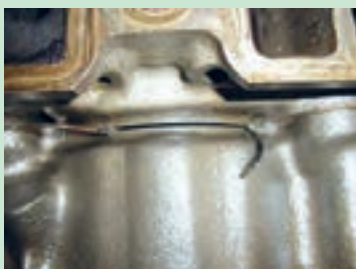
شکل ۶۲. ترک در سیلندر و بلوکه سیلندر
