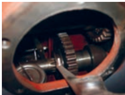
شکل ۲۱. محور تواندهی در حالت موتور گرد
