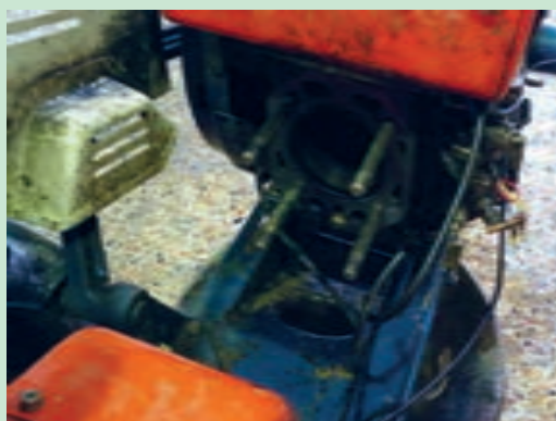
شکل ۵۶. برداشتن سر سیلندر
