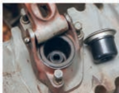
شکل ۶. مکانیزم کارانداز ترمز تراکتور MF۲۸۵
