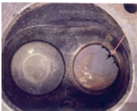
شکل ۷۰. عیوب ظاهری سوپاپ‌ها
