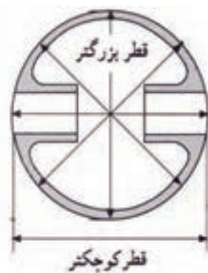
شکل ۷. اندازه قطرهای پیستون
