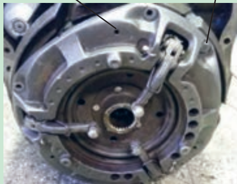
شکل ۲۵. جدا کردن مجموعه کلاچ از فلاپیول
