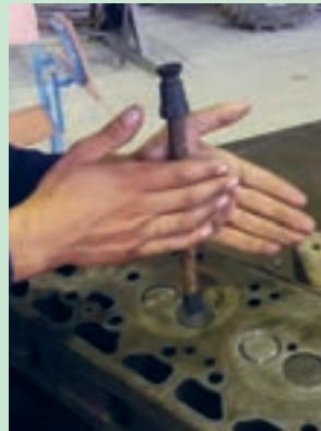
شکل ۷۹. چرخاندن سوپاپ به وسیله چوب سوپاپ گردان
