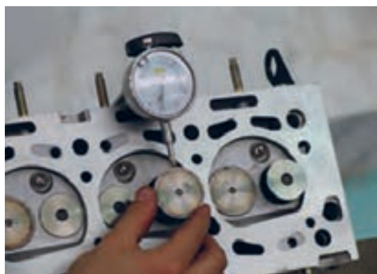
شکل ۷۳. روش کنترل لقی بین سوپاپ و گیت
