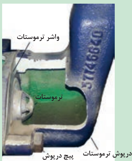
شکل ۱۷. نمای برش خورده ترموستات تراکتور MF۲۸۵
