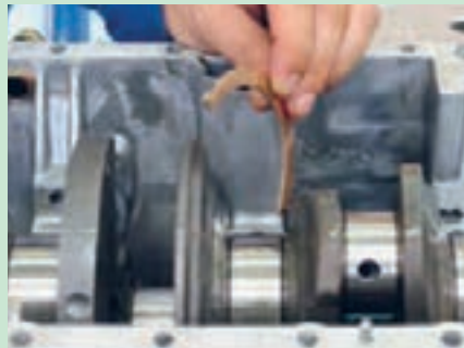
شکل ۵۰. برداشتن یاتاقان های ثابت و بغل یاتاقانی
