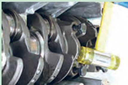
شکل ۴۷. شل کردن کپه‌های یاتاقان
