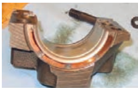
شکل ۷۳. نمونه بغل یاتاقانی معیوب
