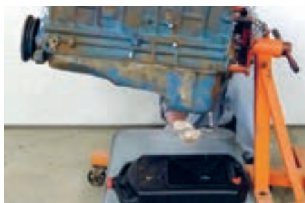
شکل ۳۳. موتور نصب شده روی استند
