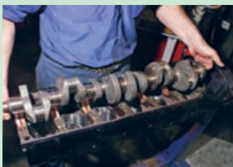
شکل ۴۹. برداشتن میل لنگ
