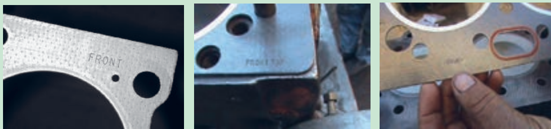
شکل ۸۶. علامت های روی واشر سرسیلندر
