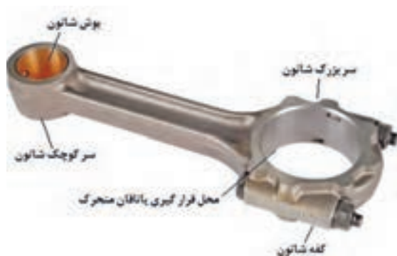
شکل ۱۳. اجزاء شاتون
