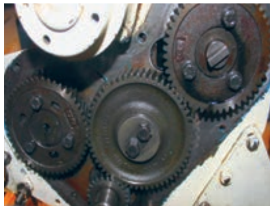
شکل ۲۷. چرخ دنده‌های تایمینگ در سینی جلو موتور
