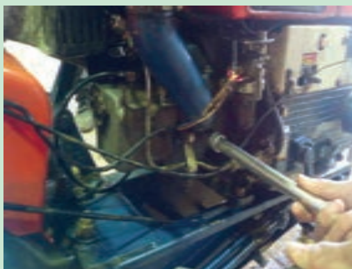
شکل ۵۲. باز کردن مانیفولد هوا
