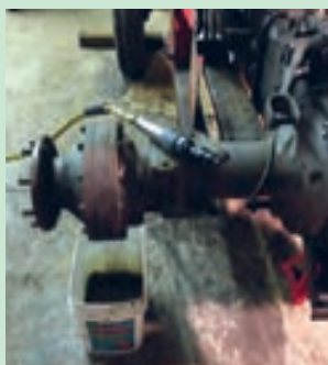
شکل ۳۲. کاهنده نهایی بعد از باز کردن چرخ
