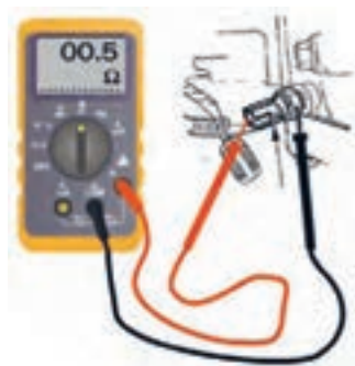
شکل ۴۹. کنترل فشنگی روغن
