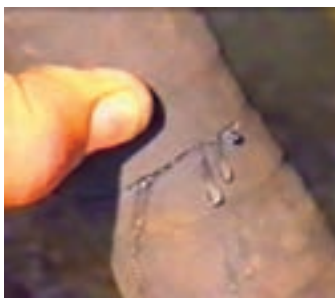
شکل ۶. نشتی از شیلنگ ها
