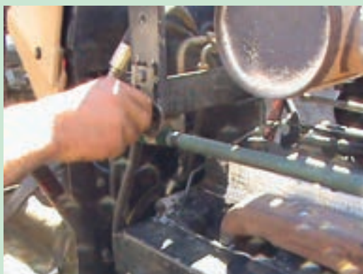
شکل ۴۱- باز کردن انباره اگزوز تراکتور MF۳۹۹
