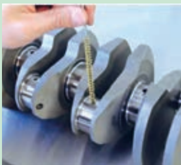
شکل ۶۰. تمیز کردن مجاری میل لنگ
