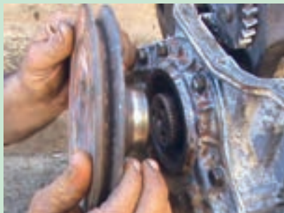
شکل ۳۵. پیاده کردن پولی میل لنگ
