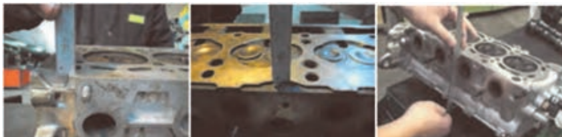
شکل ۸۳. کنترل ارتفاع مجاز کف تراشی سر سیلندر
