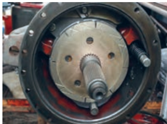
شکل ۳. پین‌های نگهدارنده مکانیسم ترمز
