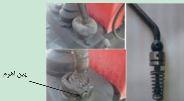
شکل ۲۹. خارج کردن اهرم‌های تعویض دنده
