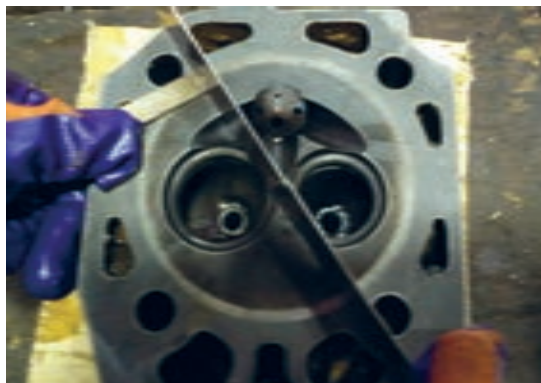
شکل ۶۵. کنترل تابیدگی سرسیلندر تراکتور دوچرخ
