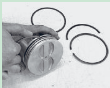
شکل ۵۸. روش های تمیز کردن شیار رینگ پیستون
