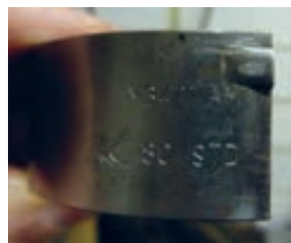
شکل ۲۳. تغییر ضخامت یاتاقان در سایزهای مختلف
