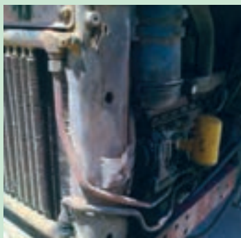
شکل ۱۳. رادیاتور روغن تراکتور U650
