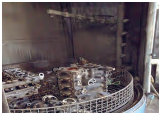
شکل ۶۱. شستشوی موتور به وسیله دستگاه شات بالاست
