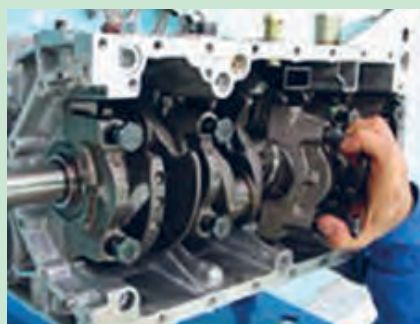
شکل ۴۸. برداشتن کپه‌های یاتاقان و چیدن آنها
