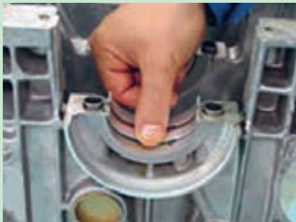
شکل ۵۰. برداشتن یاتاقان های ثابت و بغل یاتاقانی
