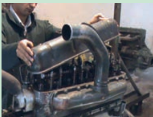
شکل ۴۴. برداشتن درپوش سوپاپ‌های تراکتور U650
