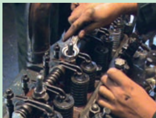
شکل ۴۵. باز کردن پیچ‌های پایه اسبک
