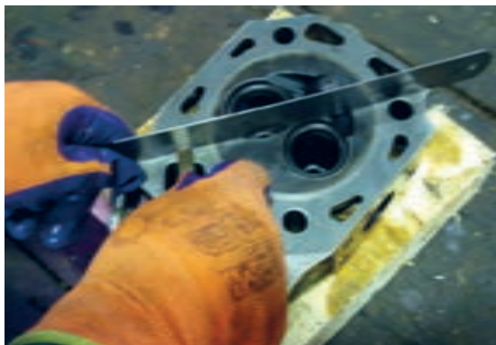
شکل ۶۵. کنترل تابیدگی سرسیلندر تراکتور دوچرخ
