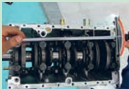
شکل ۴۶. باز کردن پیچ‌های یاتاقان
