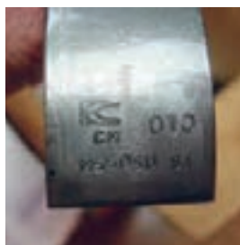
شکل ۲۳. تغییر ضخامت یاتاقان در سایزهای مختلف
