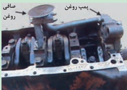
الف- محل پیچ‌های اتصال پمپ روغن به بلوک سیلندر
