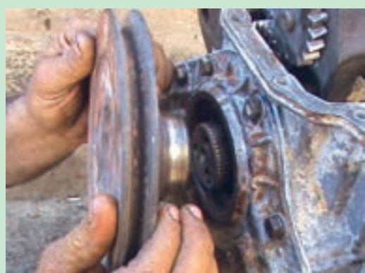
شکل ۱۱۲. جا زدن پولی سر میل لنگ
