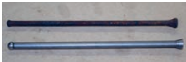
شکل ۷۶. زنگ زدن و شکستگی میل تپت
