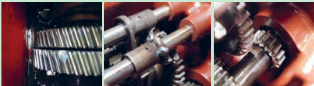
شکل ۴۰. برخی ایرادات قطعات جعبه دنده
