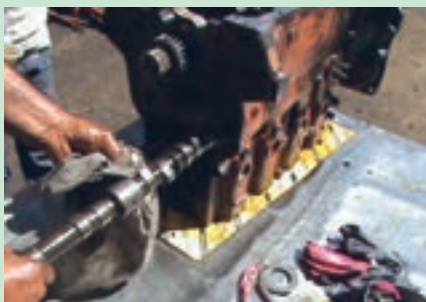
ب- خارج کردن میل سوپاپ
