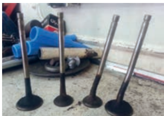
شکل ۶۷. کربن گرفتگی سرسیلندر و سوپاپ‌ها
