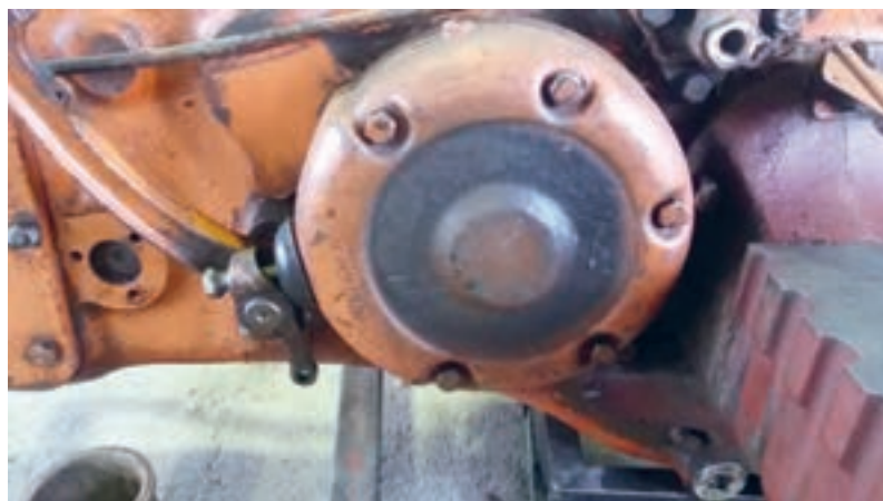
شکل ۴. موقعیت ترمز تراکتور U650
