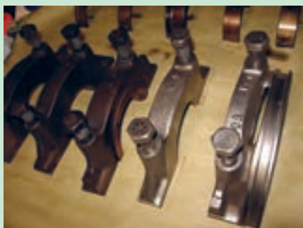
شکل ۴۸. برداشتن کپه‌های یاتاقان و چیدن آنها
