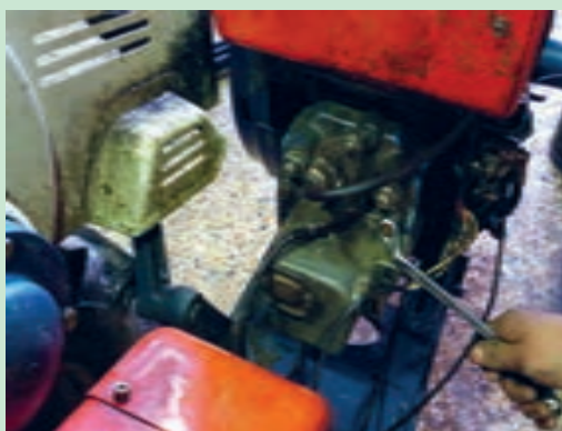
شکل ۵۳. باز کردن درپوش سوپاپ‌ها
