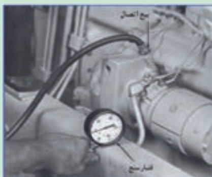
شکل ۵۰. فشار سنجی مدار روغن کاری
