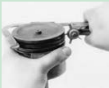
شکل ۵۸. روش های تمیز کردن شیار رینگ پیستون
