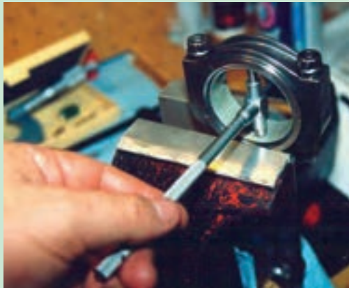
شکل ۸۳. کنترل بیضی شدن سر بزرگ شاتون
