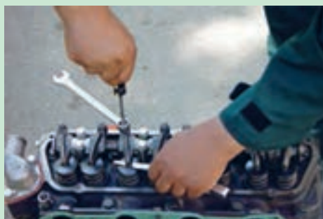
شکل ۳۶. فیلرگیری
