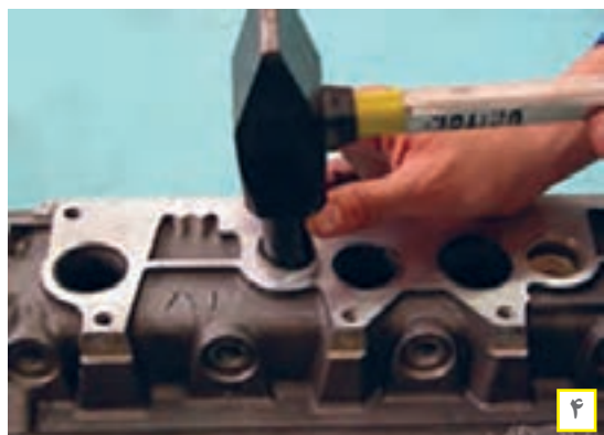
شکل ۶۹. روش تعویض پولک سر سیلندر
