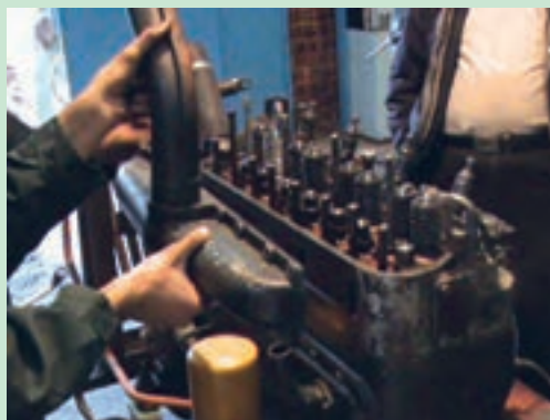
شکل ۴۳. باز کردن مانیفولد تراکتور U650
