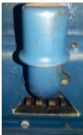
۴۰. تهویه محفظه کارتر در تراکتور U650
