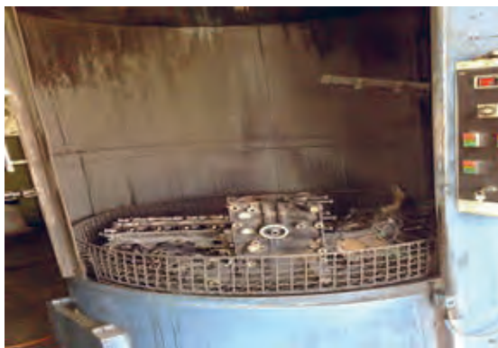
شکل ۶۱. شستشوی موتور به وسیله دستگاه شات بالاست
