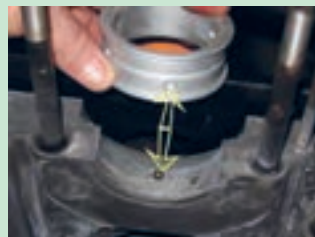
شکل ۹۳. قرار گرفتن سوراخ روغن مقابل هم
