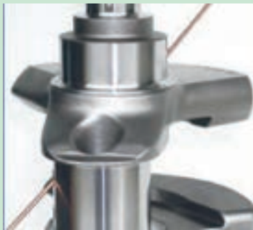
شکل ۶۰. تمیز کردن مجاری میل لنگ
