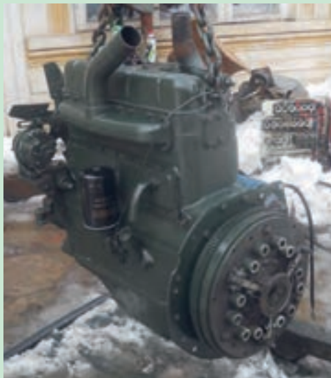
شکل ۲۴. پیاده کردن موتور تراکتور U650
