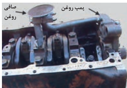
شکل ۴۱. پمپ روغن موتور و صافی آن
