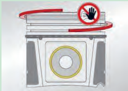
شکل ۵۳. خارج کردن رینگ بدون رینگ بازکن
