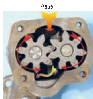
شکل ۴۲. پمپ روغن دنده ای
