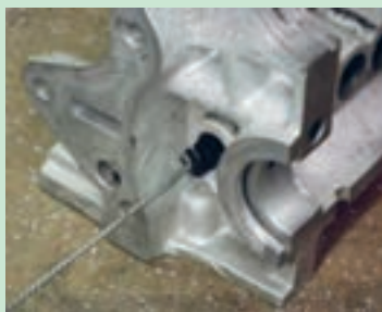
شکل ۵۹. تمیز کردن مجاری آب و روغن
