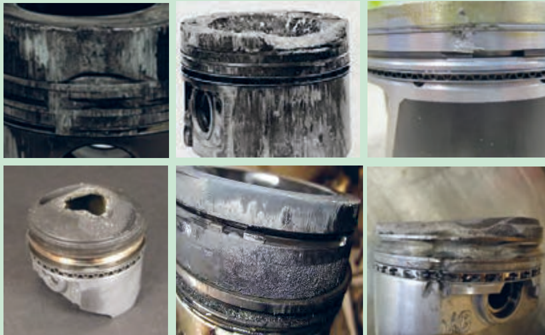
شکل ۷۴. نمونه ای از پیستون های معیوب
