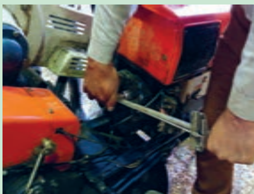
شکل ۵۵. باز کردن سر سیلندر
