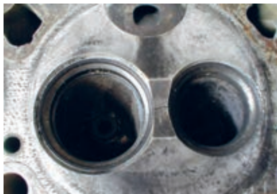
شکل ۶۶. ترک خوردگی سرسیلندر در محفظه احتراق
