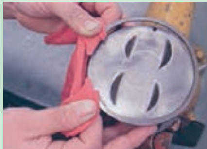
شکل ۵۳. خارج کردن رینگ بدون رینگ بازکن
