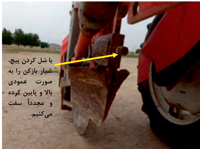
شکل ۲۰ - تنظیم شیار بازکن
