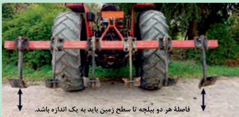
شکل ۱۴- تراز طولی شیارک
