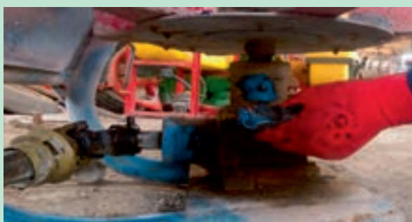
شکل ۱۳- تمیز کردن گریسخورها و مکان آنها
