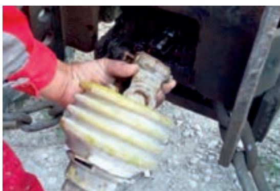
شکل ۱۱- اتصال گاردان به تراکتور
