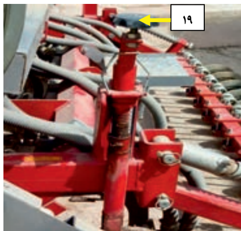
شکل ۳۹- اهرم تنظیم عمق کاشت
