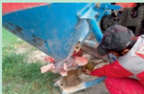
شکل ۹- نصب گاردان بین بذرپاش و تراکتور
