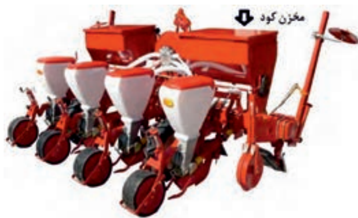
شکل ۱۰- ساختمان یک پنوماتیک با کودکار
