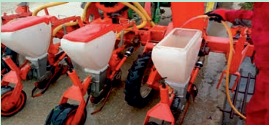
شکل ۱۱- شستشو و تمیز کردن ماشین ردیف‌کار
