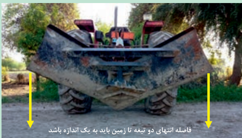
شکل ۲۵- تنظیم تراز عرضی نه‌رکن
