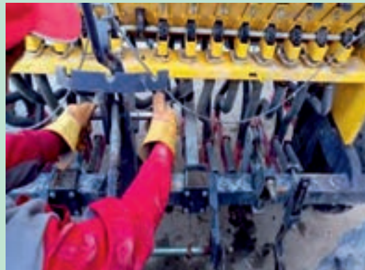
شکل ۱۳- متصل کردن خطی کار به تراکتور
