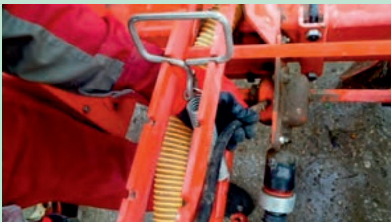
شکل ۱۲- گریس‌کاری تمام گریس‌خوره‌های ماشین ردیف‌کار
