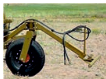
شکل ۴۹- ماشین دیم کار کششی با تک نقطه اتصال و شیلنگ های هیدرولیک
