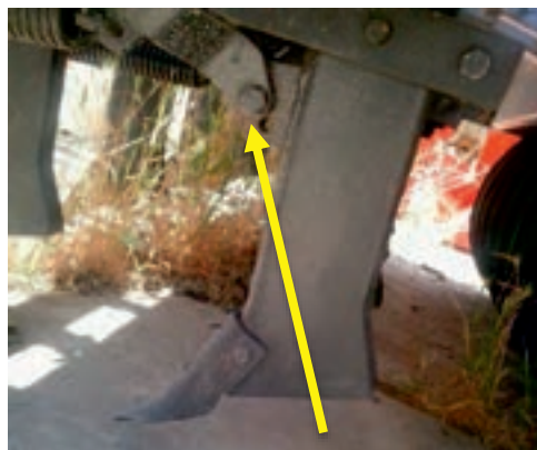
شکل ۵۴- سوراخ روی بازوی بیلچه شیار بازکن
