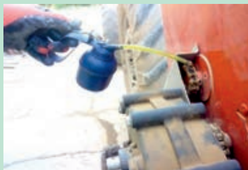
شکل ۴۳- روغن کاری چرخ دنده‌ها
