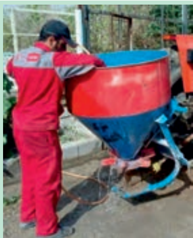
شکل ۱۲- تمیز کردن بذرپاش
