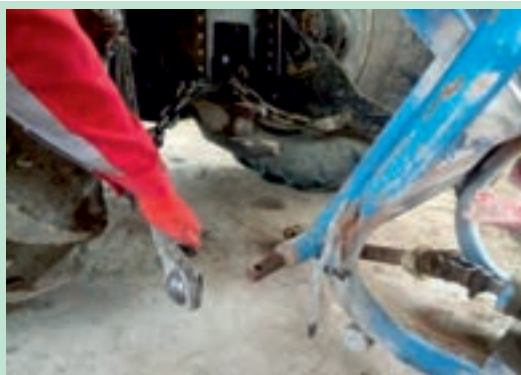
شکل ۸- اتصال بذرپاش به بازوهای کناری تراکتور
