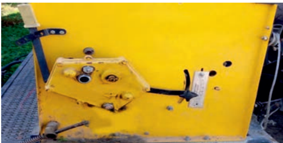
شکل ۱۵- جعبه دنده و درجه ریزش بذر
