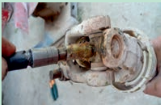
شکل ۱۵- گریس کاری گاردان و بذریاش
