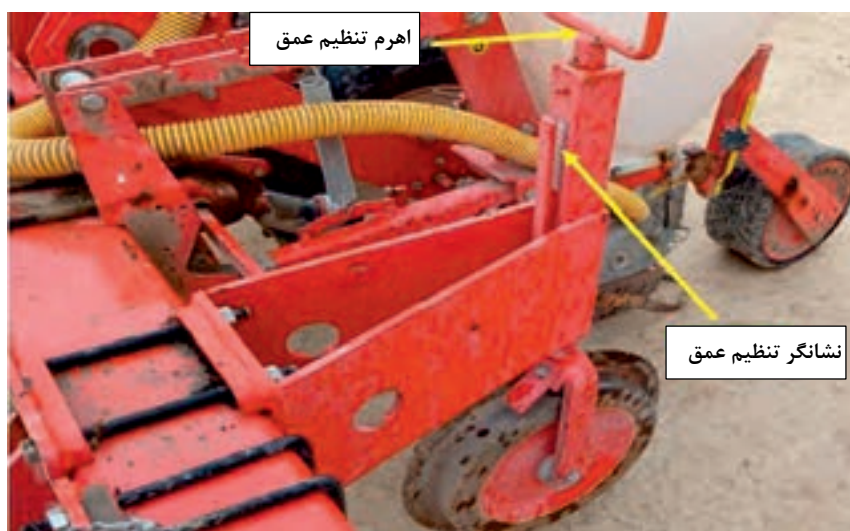
شکل ۱۸- تنظیم عمق کاشت
