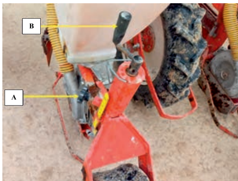
شکل ۲۱- تنظیم چرخ فشار دهنده
