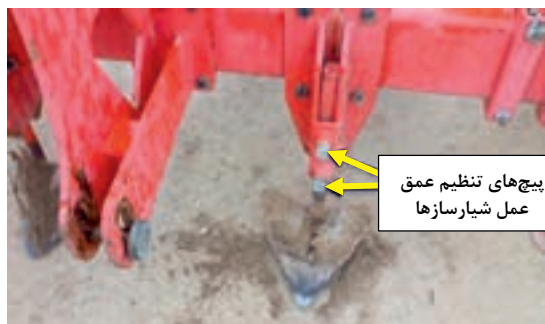
شکل ۱۷ - پیچ‌های تنظیم عمق شیارساز
