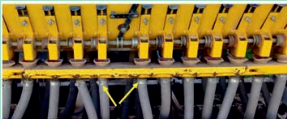
شکل ۲۸- بست‌های نگهدارنده لوله‌های سقوط
