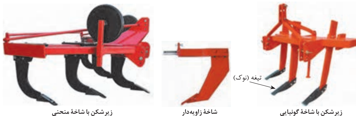
شکل ۱۲-۱. زیر شکن و انواع شاخه‌های آن
