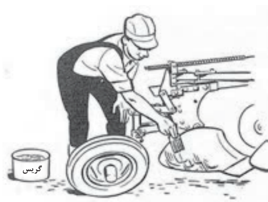
شکل ۵۲-۱. اندود کردن قطعات گاوآهن با مواد ضدزنگ
