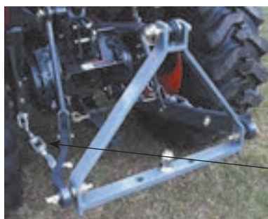
زنجیر تعادل (نوسان گیر) شکل ۲۷-۱
