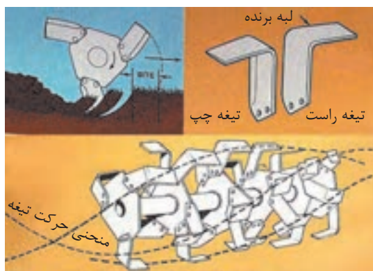
شکل ۱۵-۱. آرایش مارپیچ تیغه‌های گاواهن دوار
