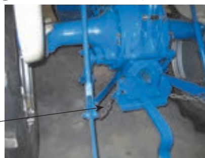
زنجیر تعادل (نوسان گیر) شکل ۲۷-۱
