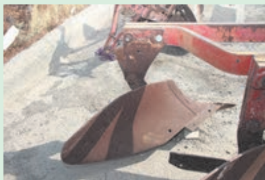
شکل ۲۱-۱. پین بریده شده در گاوآهن
