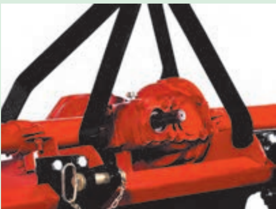
شکل ۲۳-۱. محور انتقال نیرو و نقاط اتصال
