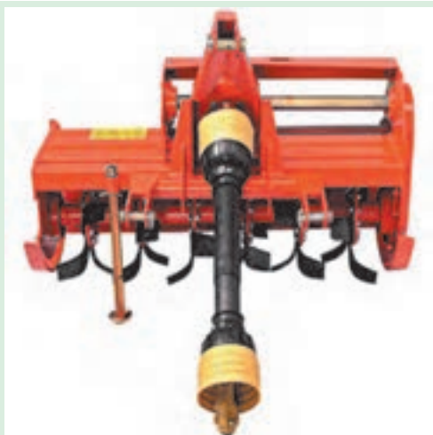
شکل ۲۵-۱. گاردان متصل به رتیواتور
