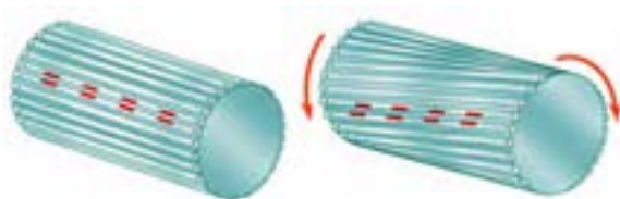
شکل ۲۴-۴- پیچش در یک قطعه
