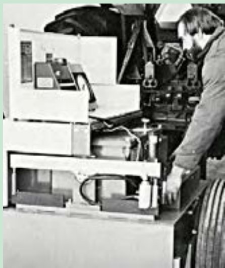
شکل ۳-۳۵- برای اندازه گیری توان تراکتور از دستگاهی به نام دینامومتر استفاده می شود.
